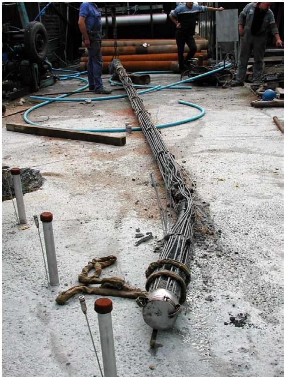
Figur 7.9. Det optagne Varmelegeme 1 i fuld udstrækning. Bunden nærmest kameraet. Det ses tydeligt, at røret indeni er kollapset umiddelbart over bunden som følge af opvarmningen.
