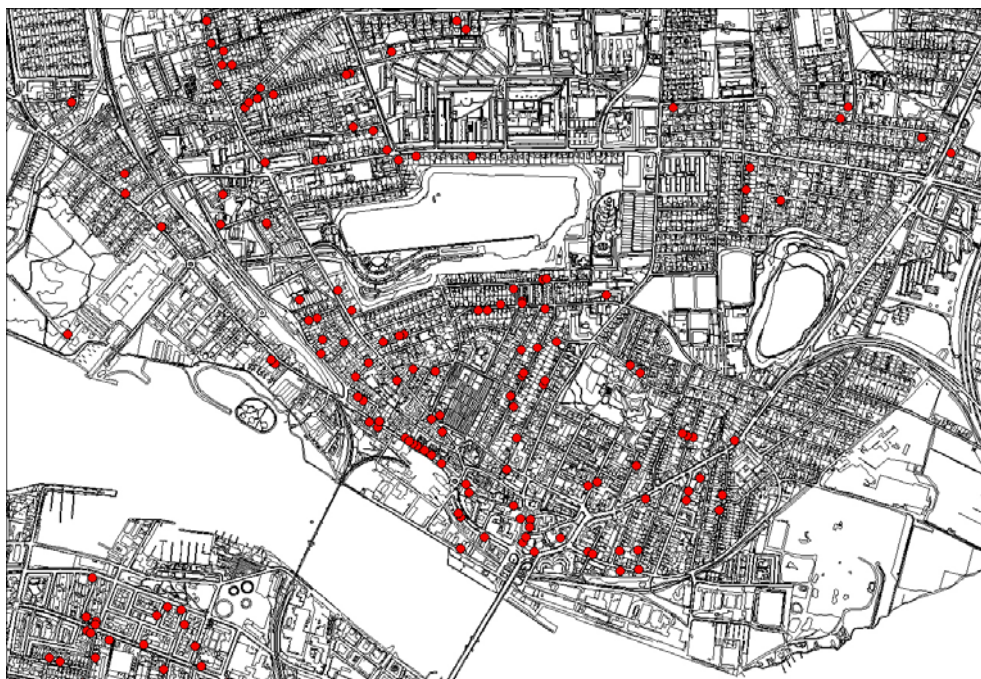
Figur 6: Registrerede vandskader i Nr. Sundby som følge af ekstremregnen 21. august 2006.
