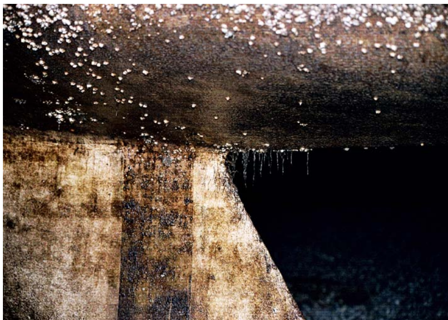
Foto 5.7 - Begroning Yndling: Slim (50-100%), alger (5-25%), bryozoer (0%), rurer (25-50%), muslinger (0-5%). Kontrolmaling: Mere slimet og flere rurer end testmalingen særligt på skroget.
