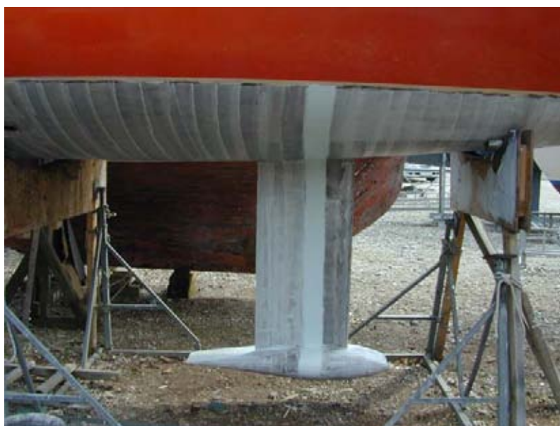
Foto 4.1 - Testbåds udseende efter påføring af to lag bundmaling som foreskrevet.
