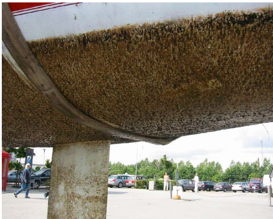
Foto 5.9 - Begroning Banner 28: Slim (50-100%), alger (50-100%), mosdyr (0%), rurer (0%), muslinger (0%). Kontrolmaling: Slim og alger (50-100%) lidt mindre begroning på nederste del af kølen.
