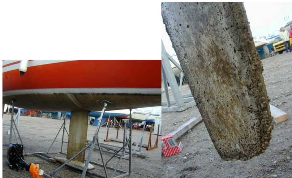
Foto 5.11 - Begroning Banner 28: Slim (50-100%), alger (50-100%), mosdyr (0%), rurer (0-5%), muslinger (0%). Kontrolmaling: Lidt mindre på nederste del af kølen (den "hvide" stribe på skroget er forårsaget af kranstroppen og er altså ikke kontrolmalingen).
