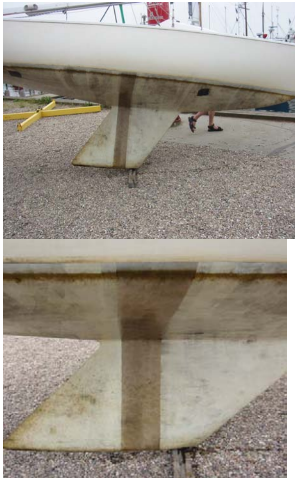
Foto 1.4 - Båd, der er malet med enzymmal ing. Striben, der ses gennem bund og køl, er malet med samme mal ing uden tilsætning af enzym.
