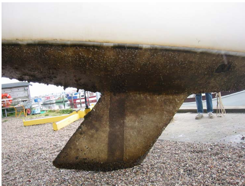
Foto 5.3 - Begroning Yngling: Slim (50-100%), alger (5-25%), bryozoer (0%), rurer (50-100%), muslinger (25-50%). Kontrolmaling: Lidt mere slimet og lidt flere kiselalger end på testmalingen - særligt på skroget.
