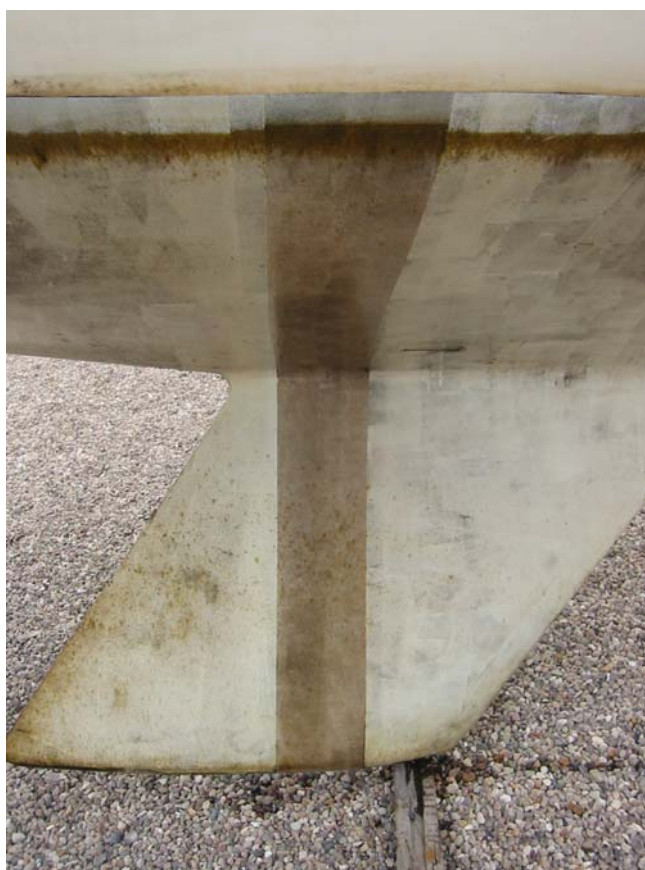
Foto 5.2 - Der er tydelig mere begroning på kontrolmalingen (den smalle stribe midtskibs).
