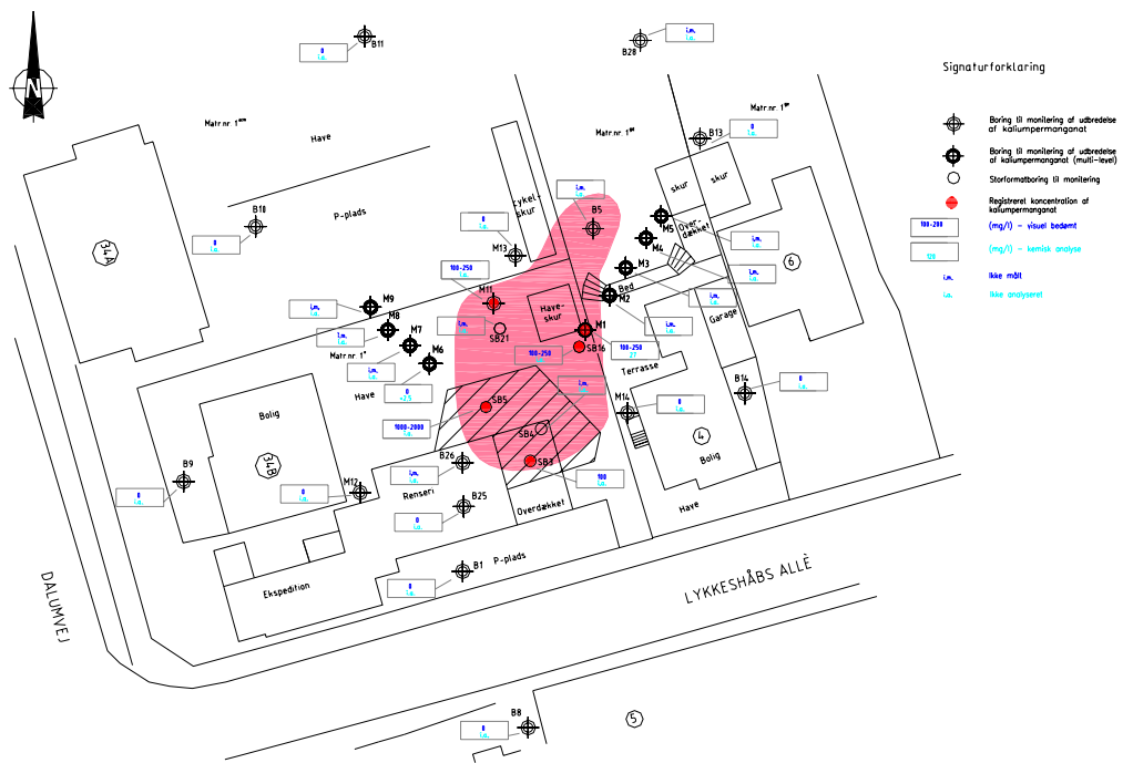
Figur 5.6: Udbredelse af \text{KMnO}_4 (10. måned, 11. august 2003), (figuren ses i større format i bilag 3.8.4).
