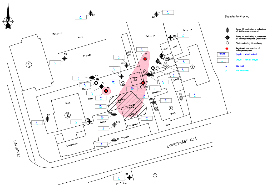
Figur 5.8: Udbredelse af \text{KMnO}_4 (18. måned, 14. april 2004), (figuren ses i større format i bilag 3.8.6).
