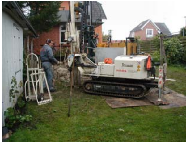
Figur 4.9: Udførelse af geoprobeforundersøgelse (GS7).
