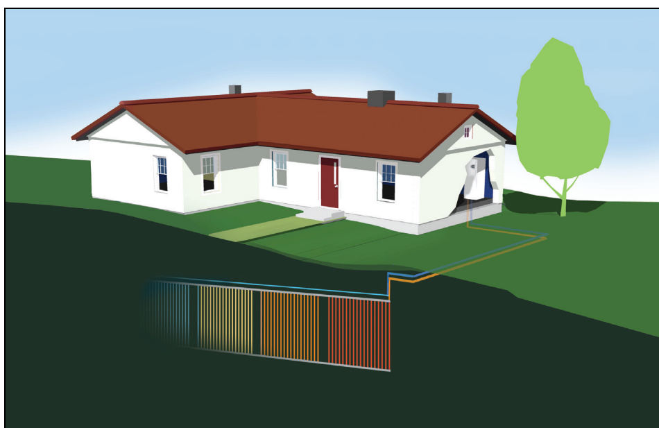
Figur 2.5 Jordvarmeanlæg med kollektorer. Figur fra IVT Naturvarme.
