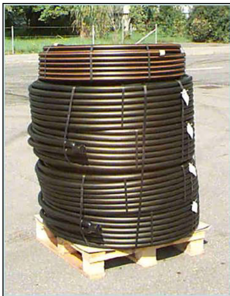
Figur 10 Varmeslanger til installation i en jordvarmeboring. I dette anlæg anvendes to U-rør, som er støbt i bunden. Øverst ligger en slange til nedpumpning af bentonit/cementsuspension. Fra Rotek A/S.
