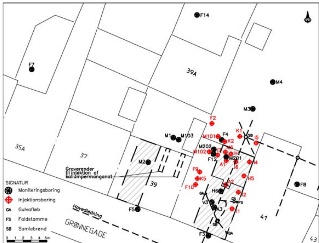
Figur 5.2 Placering af injektions- og monitoringsboringer samt kloakker
