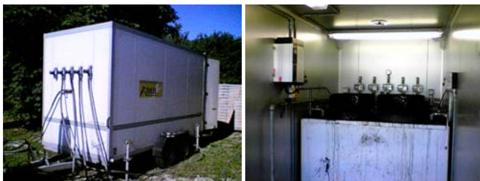
Foto 5.1 og 5.2 Trailer til opblanding af kaliumpermanganat på fast form med vand
