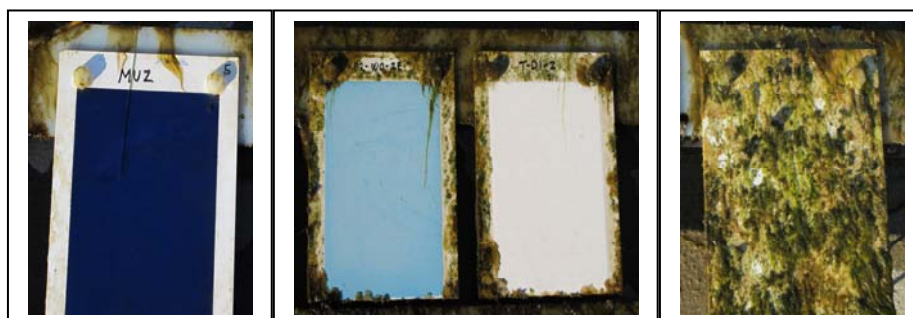
Figur 1.5. Malingerne har været eksponeret i Horsens havn ca. 5 måneder (oktober 2010). Billedet længst til venstre er referencen. De 2 midterste paneler er forsøgsprodukter med indkapslet Zinc pyrithione < 1 vægt-% i våd maling. Panelet længst til højre er en blank panel. Resultatet for forsøgsprodukterne er på dette tidspunkt godt.
