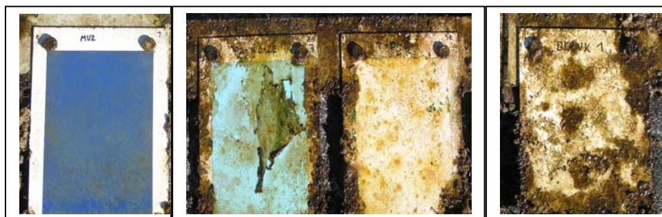
Figur 1.1. Malingerne har været eksponeret i Jyllinge havn ca.3 måneder (2. September). Billedet længst til venstre er referencen MU2. De 2 midterste paneler er forsøgsprodukter med indkapslet Zinc pyrithione < 1 vægt-% i våd maling. Panelet længst til højre er en blank panel. Resultatet for forsøgsprodukterne er på dette tidspunkt rimeligt.
