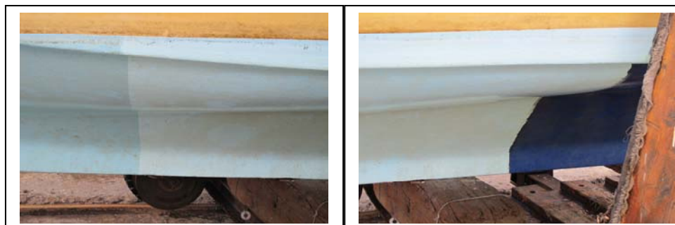
Figur 1.10. Inspektion den 10. september, bagbord side. Til venstre ses Testmaling 2 og 1 og til højre testmaling 1 og referencemalingen. Der kan ikke ses nogen tydelig forskel i begroning på de tre felter. Foto: Eva Wallström.
