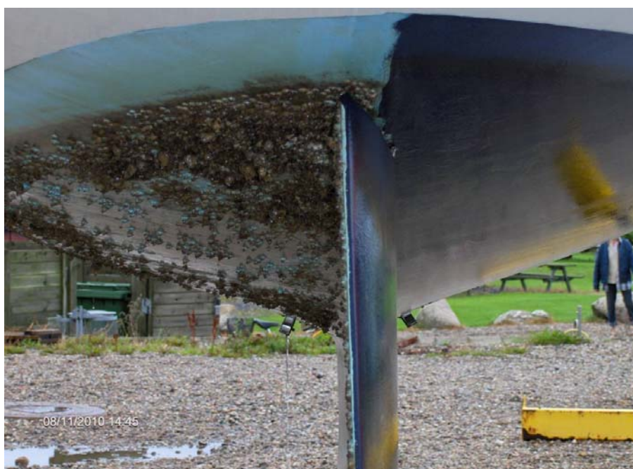
Figur 1.4. Sejlbad i Horsens inspiceret den 11. august. Testmaling 1 (feltet til venstre) var mest begroet. Feltet til højre er referencemalingen.
