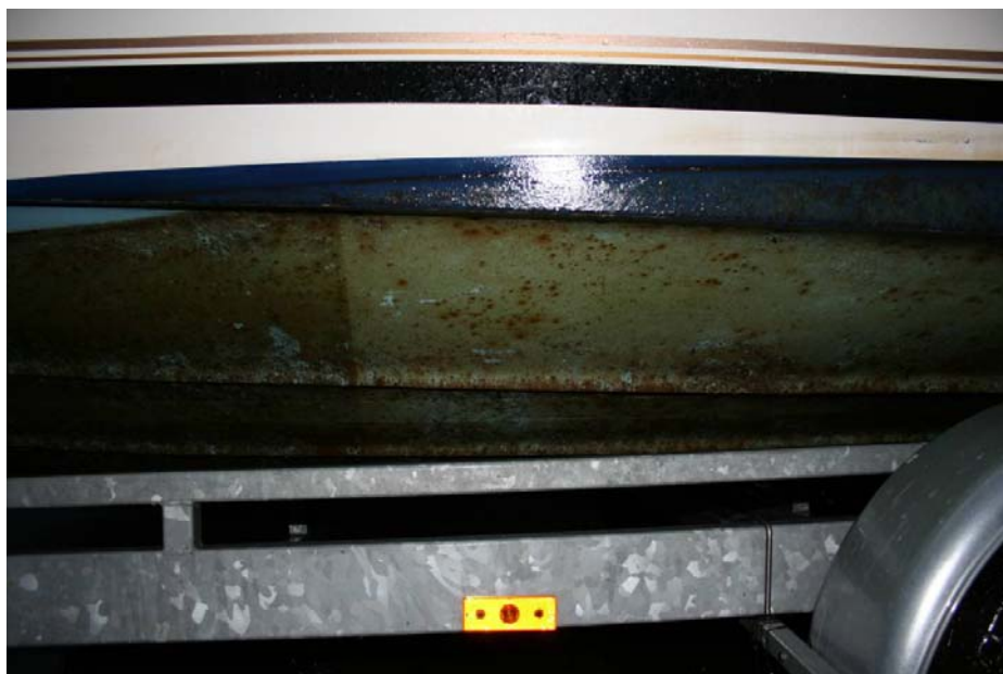
Figur 1.8. Inspektion ved optagning den 27. oktober. Bagbord side (vist på billedet) var mest begroet. Feltet til venstre er Testmaling 2 og til højre ses Testmaling 1.
