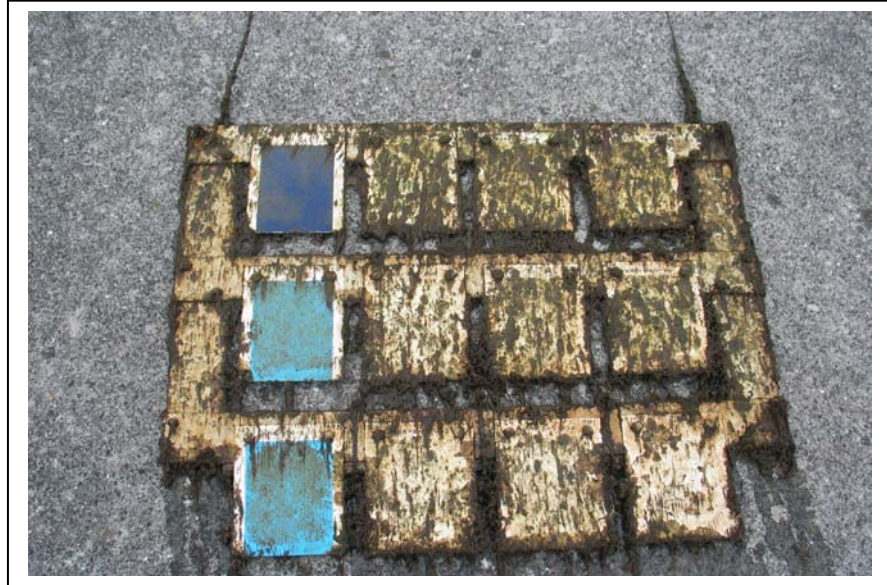
Figur 1.4. Panelerne har været eksponeret i Jyllinge havn knap. 6 måneder. Billedet er taget 23. oktober. Referencen har et slim/algelag. De lyseblå svarer til referencen i forhold til begroning. De vandfortyndbare malinger er mere begroet.
