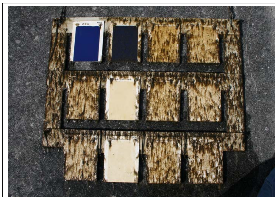
Figur 1.1. Paneler der har været eksponeret i Jyllinge havn i 6 uger. Billedet er taget 16. juni. Det kan ses at MU2 er pænt ren, men uden zinkpyrithione får den algebegrøning og ser mere mørkeblå ud. Til gengæld er der en vandfortyndbar der ser ud til at give gode resultater. Dette er hvor der anvendes indkapsler zinkpyrithione (<0,5 %).
