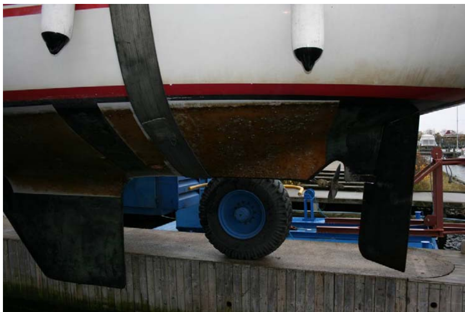
Figur 1.6. Inspektion af sejlbad i Jyllinge den 2. november bagbord side. Feltet til venstre er malet med Testmaling 2 og feltet til højre med Testmaling 1. Det øvrige skrog er påført referencemaling der som det fremgår er mindre begroet end testmalingerne. Foto Jesper Højenvang
