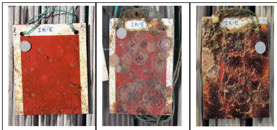
Billede 1.3. Forsøgsprodukt med rødt pigment med en tom aerogel (0,5 vægt-%) i den våde maling. Denne er således biocidfri og har været eksponeret i 21, 56 og 88 dage fra venstre til højre, hvor begroingen bliver kraftigere og kraftigere.
