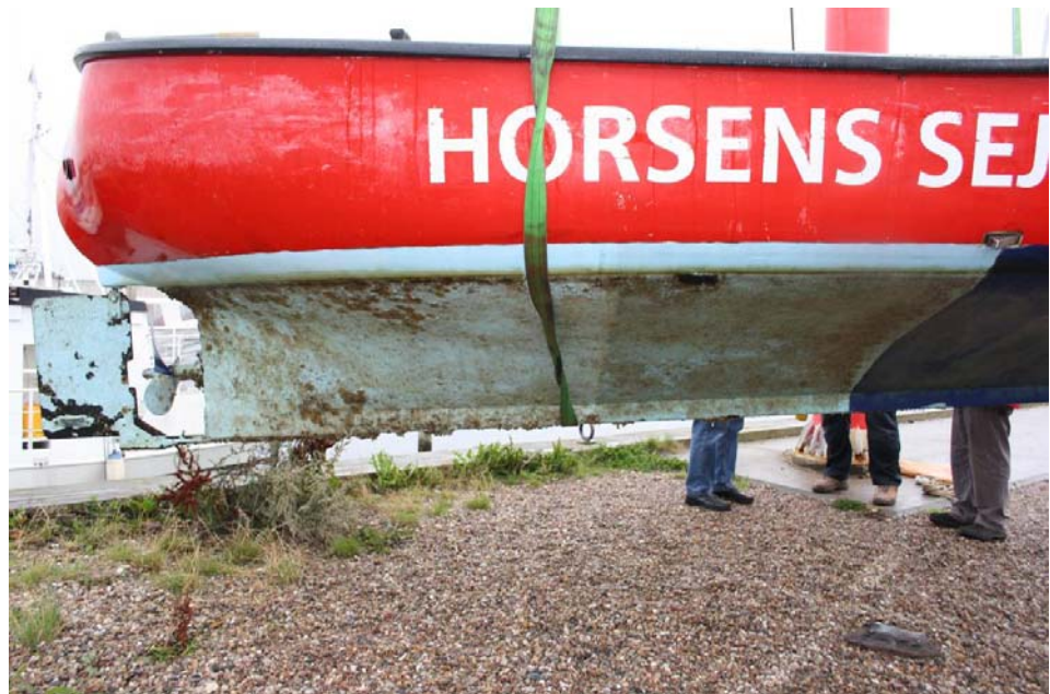
Figur 1.1. Motorjolle i Horsens inspiceret den 12. august. Testmaling 1 (lys) - feltet yderst til venstre, var mest begroet. Foto: Jesper Højenvang.
