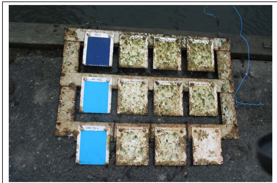
Figur 1.5. Panelerne har været eksponeret i Jyllinge havn knap. 6 måneder. Billedet er taget 23. oktober, men efter spuling med vand. Reference og de lyseblå malinger er rene.
