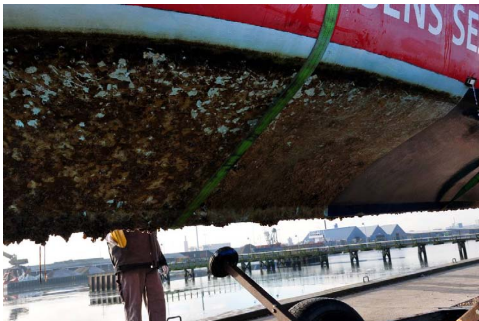
Figur 1.2. Motorjolle i Horsens inspiceret ved optagning i november måned. Begroningsmængden på testmalingerne var, særlig på styrbord side (vist på billedet) kraftig sammenlignet med referencen (yderst til højre) og bestod bl.a. af rurer, Broyzoer samt muslinger. Foto: Carl Gerstrøm.
