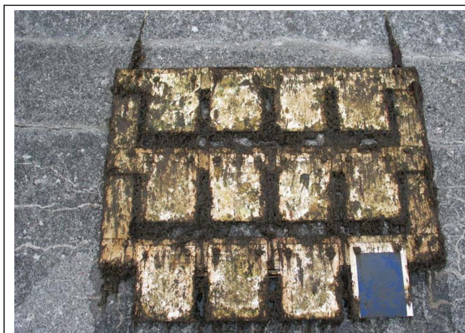
Figur 1.7. Panelerne har været eksponeret i Jyllinge havn knap. 6 måneder. Billedet er taget 23. oktober, Referencen har et slim/algelag. Den tredje kolonne har tilsvarende slim/algelag, men det sidder mere fast..
