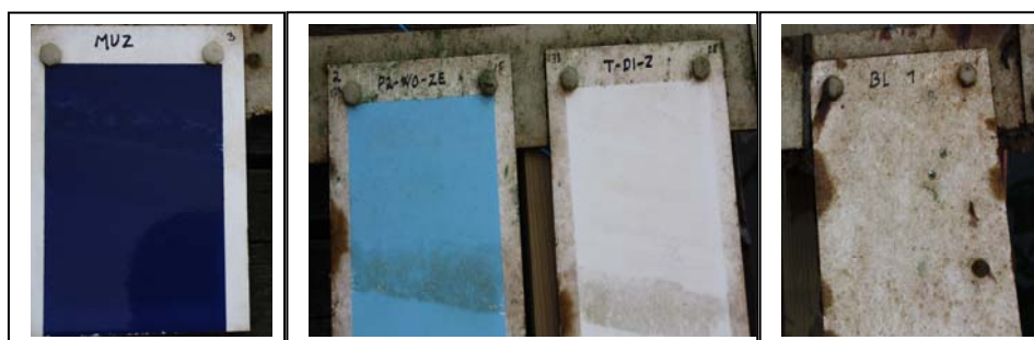
Figur 1.3. Malingerne har været eksponeret i Horsens havn ca.2,5 måneder (august 2010). Billedet længst til venstre er referencen. De 2 midterste paneler er forsøgsprodukter med indkapslet Zinc pyrithione < 1 vægt-% i våd maling. Panelet længst til højre er en blank panel. Resultatet for forsøgsprodukterne er på dette tidspunkt rimelig godt.
