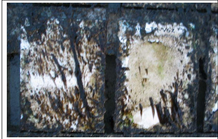
Figur 2.3. Paneler der har været eksponeret i Svanemøllen havn i ca. 5 måneder. Panelet til venstre indeholder gel hvor ZnP er udenfor. Panelet til højre gel med indkapslet ZnP. Der er en kvalitativ forskel i begroning. De hvide streger er kontrol af om begroningen sidder fast med en finger.
