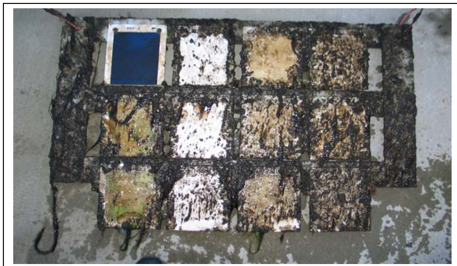
Figur 2.1. Paneler der har været eksponeret i Svanemøllen havn i ca. 5 måneder. Referencen MU2 er rimelig god. Kolonne 2 er den bedste af forsøgsprodukterne.
