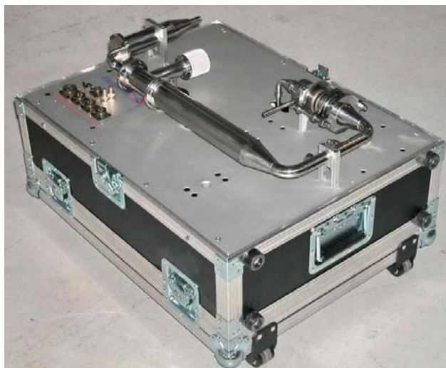
Figur 10. Transportabelt fortyndingsudstyr Micro-PSS til måling af partikelemissioner fra dieselmotorer, udviklet af det italienske firma Control System. Kilde: /21/. Micro-PSS er bygget til gravimetrisk bestemmelse i henhold til ISO 16183 /22/, men kan også anvendes til måling med kontinuert registrerende instrumenter såsom CPC. Model len på figuren vejer ca. 39 kg og er transportabel.
