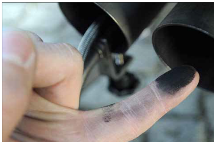
Figur 31 Det er almindeligt kendt at udstødningsrøret fra et vel fungerende diesel partikel filter ikke er sværtet.. Kilde MAHA /42/.
