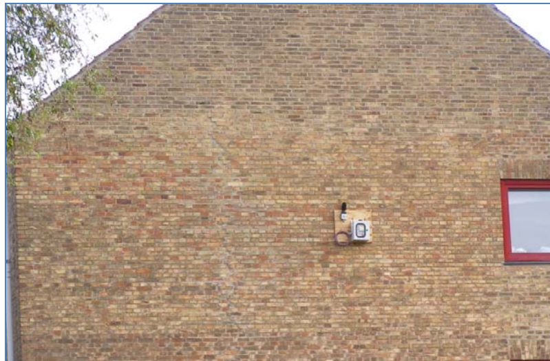
Figur 4 Permanent støjmåling ved anlægsarbejde i København
