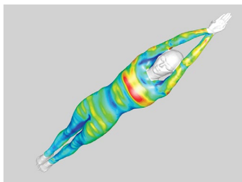
Figur 2 CFD-analyse af Speedo svømmedragt, billede fra nettet
