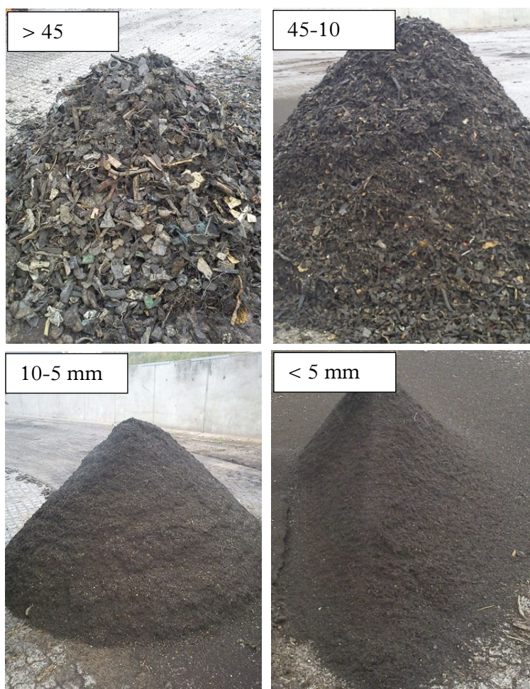
FIGUR 4-2 STØRRELSSEFRAKTIONERET SHREDDERAFFALD SIGTET IGENNEM TRE SIGTER MED AF-SKÆRINGSDIAMETRE PÅ HHV. 45 MM, 10 MM OG 5 MM.
