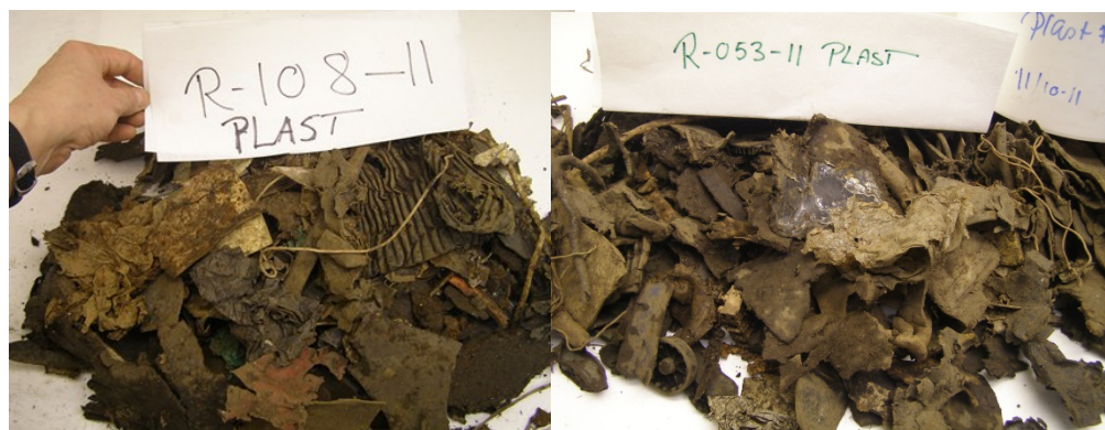
FIGUR 5-6 PLAST FRASORTERET VED HÅNDSORTERING AF DEPONERET SHREDDERAFFALD > 45 MM FRA HHV. AV MILJØ (R-108-11) OG ODENSE NORD MILJØCENTER (R-053-11).
