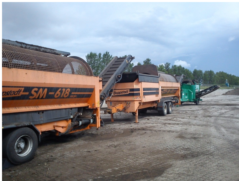
FIGUR 4-1 ANLÆG TIL STØRRELSSEFRAKTIONERING AF SHREDDERAFFALD OPSAT PÅ ODENSE NORD MILJØCENTER
