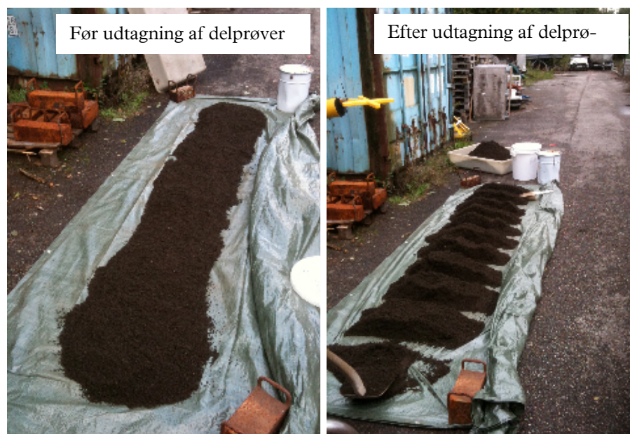
FIGUR 4-4 NEDDELING AF PRØVER AF SHREDDERAFFALD MODTAGET FRA ODENSE NORD MILJØ-CENTER VHA. MILEPRINCIPPET.
