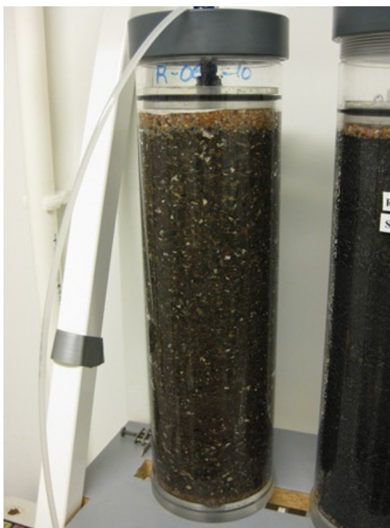
FIGUR 4-5 KOLONNEUDVASKNINGSTEST UDFØRT PÅ FRAKTIONER AF SHREDDERAFFALD, SOM ER MINDRE END 5 MM.
