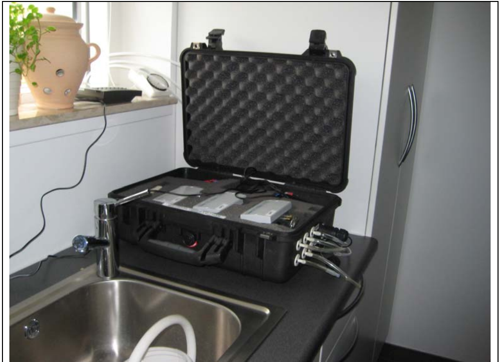
3: Installation af tryklogger og vejrstation i indeklima. Placering i bryggers.
