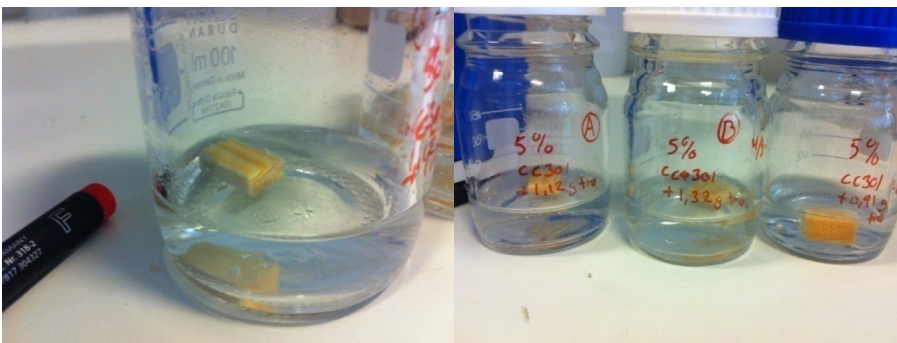
Figur 2.7. Indledende forsøg til analyse af silikapartiklers indtrængning i træ. Silikapartiklerne findes i væsken, og silikakoncentrationen heri måles før og efter, ligesom tørstofindholdet af silika i træstykkerne bestemmes efter behandlingen.
