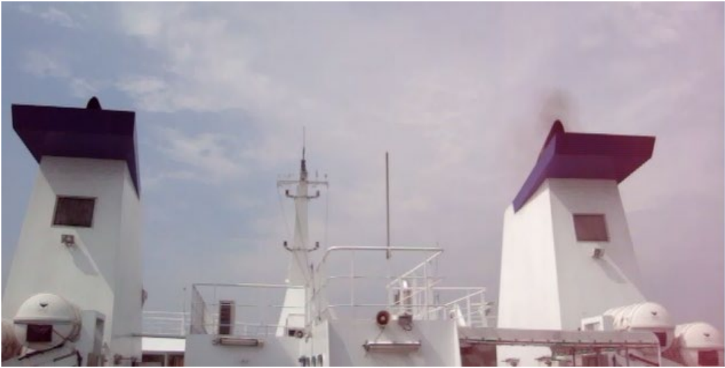
Figur 8: Havnemanøvre med indkoblet partikelfilter i bagbord side.
