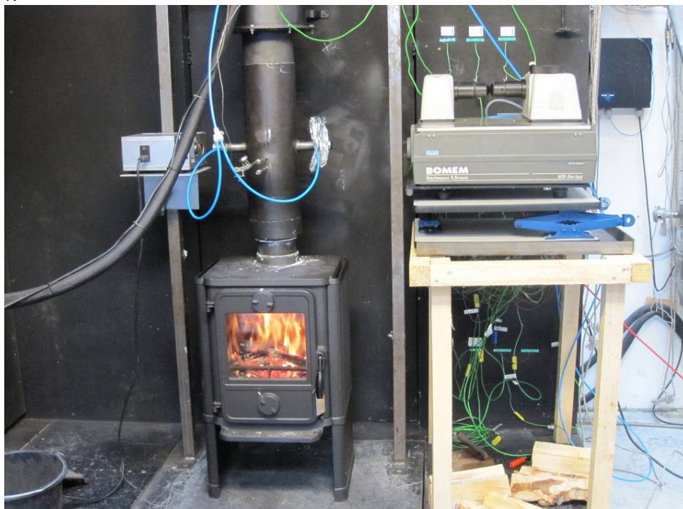
Fig.7. Teststand på TI Århus med opstilling til måling af CO i røgrør med FTIR.
