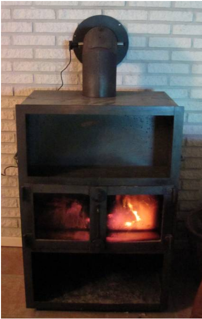
Fig. 11. Test setup tilsmudsning af vinduer på ovn 1.
