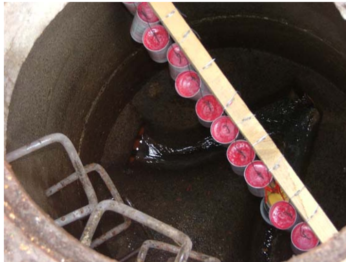
Billede 3.1 - Testmaterialet ophængt til ældning i kloakken.
