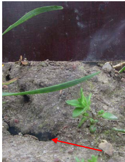
FIGUR 2-18. KRAFTIG RØGFANE FRA EN MAKROPORE I JORDOVERFLADEN (POREN ER VIST MED RØD PIL) FOTOGRAFERET DEN 3. MAJ 2010. DEN ØVERSTE DEL AF FANEN SES FORHOLDSVIS LET MOD DEN MØRKE TRÆPLADE, MENS DEN NEDERSTE DEL AF FANEN "FORSVINDER" MOD DEN LYSE BAGGRUND. FANEN SOM HELHED VAR MEGET NEM AT SE I MARKEN.
