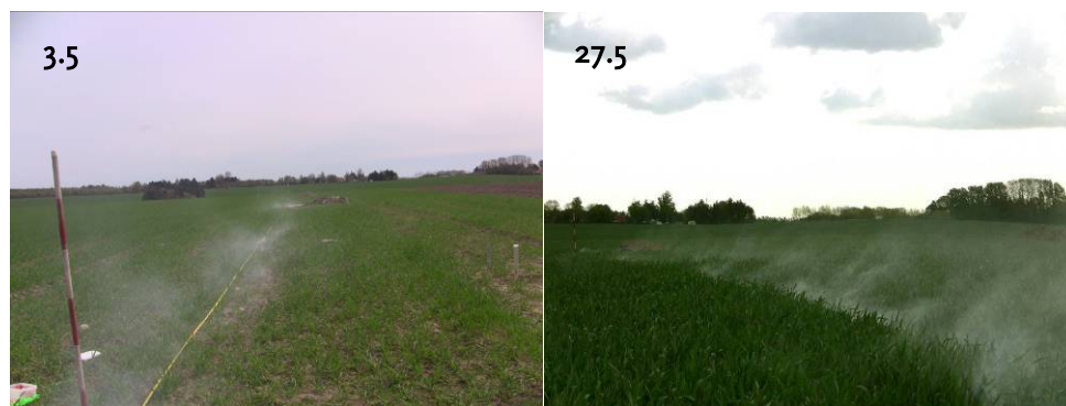
FIGUR 1 RØGAFGIVELSE FRA MAKROPORER I JORDOVERFLADEN OVER EN 35 M LANG DRÆNLEDNING NEDGRAVET FOR 45 ÅR SIDEN I 120 CM DYBDE. RØGEN BLEV BLÆST IND I DRÆNET I FORGRUNDEN UNDER LAVT TRYK, MENS DEN FJERNE ENDE AF DRÆNSEKTIONEN VAR BLOKERET. RØGFANERNES PLACERING I FORHOLD TIL DRÆNET BLEV BESTEMT MED MÅLEBÅND. BILLEDERNE ER TAGET 3.5 OG 27.5 2010.
