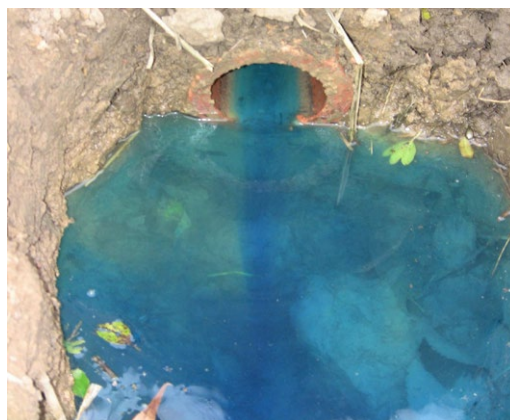
FIGUR 2. UDSTRØMNING AF BLÅFARVET VAND FRA ET DRÆNUDLØB 29 M NEDSTRØMS I FORHOLD TIL TILFØRSELSSTEDET. DER BLEV I LØBET AF 20 MIN TILFØRT 7,8 L BLÅFARVET VAND PÅ JORDOVERFLADEN TIL EN ÅBENTSTÅENDE, KRAFTIGT RØGGIVENDE REGNORMEGANG, BILLEDET BLEV TAGET UMIDDELBART EFTER TILFØRSELN.
