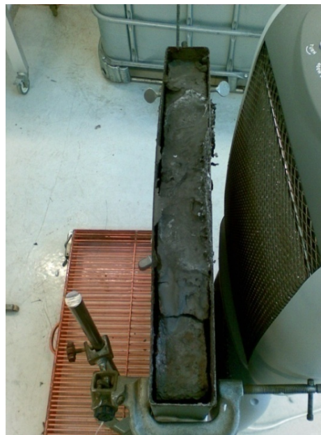
BILLEDE 8: DEN STØRKNEDE BLANDING SLIPPER BEHOLDERSIDERNE
