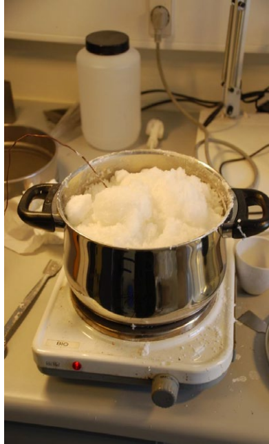
BILLEDE 1: FORSØG MED SMELTNING AF SALTHYDRAT
