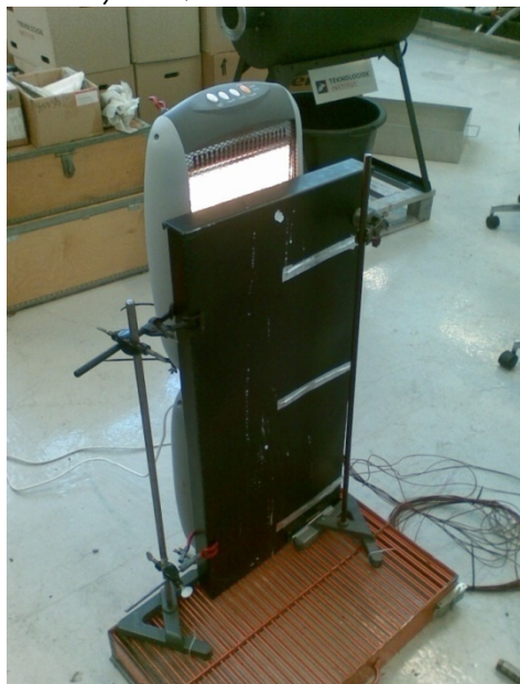
BILLEDE 7: FORSØGSOPSTILLING MED TO HALOGENLAMPER
