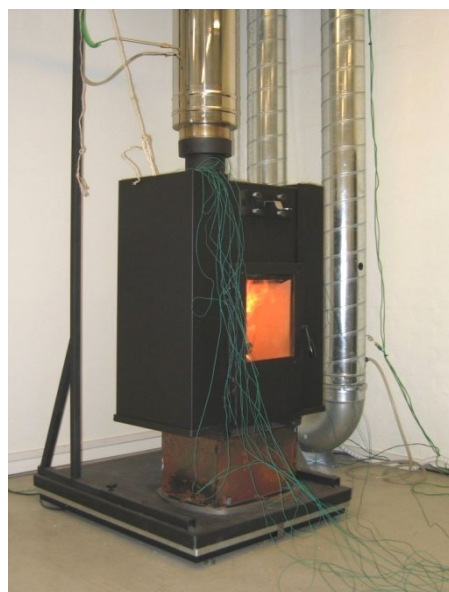
BILLEDE 3: PROTOTYPE MED PCM VARMELAGER PÅ NORSK PRØVESTAND
