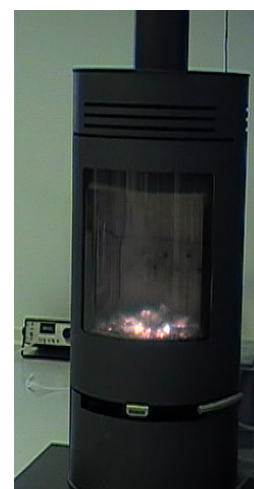
Forbrænding ved glødelag efter vinduet igen er åbnet
