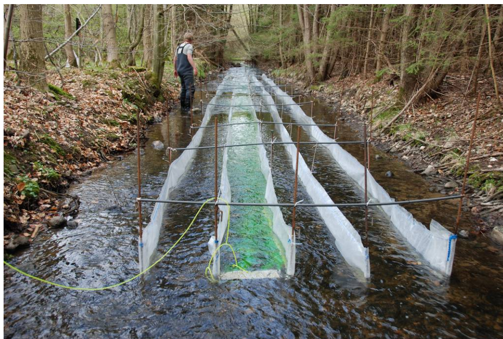
FIGUR 2.1. FORSØGSSTRÆKNINGEN I STAVIS Å VISENDE DE 4 FORSØGSRENDER (SET I NEDSTRØMS RETNING). RENDERNE ER NUMMERET 1 TIL 4 REGNET FRA VENSTRE: R1 – EKSPONERET MED PYRETHROID 4 GANGE, R2 – EKSPONERET 2 GANGE MED PYRETHROID, R3 – EKSPONERET 1 GANG MED PYRETHROID, R4 – IKKE EKSPONERET MED PYRETHROID. FOTO'ET VISER OGSÅ AFPRØVNINGEN AF TÆTHEDEN AF RENDERNE VED BRUG AF GRØNT FARVESTOF (URANIN). FOTO: P. WIBERG-LARSEN.
