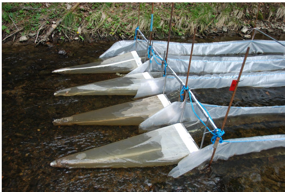
FIGUR 2.3. DRIFTNET ANVENDT TIL OPSAMLING AF DE MAKROINVERTEBRATER, SOM MED STRØMMEN DREV UD AF RENDERNE I FORBINDELSE MED EKSPONERINGERNE MED PYRETHROID.
