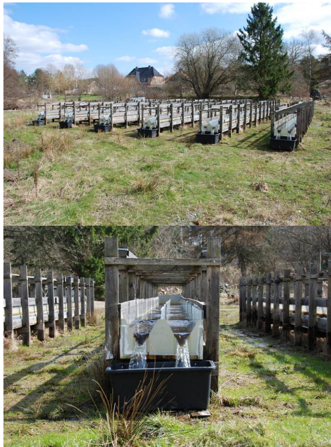
FIGUR 2.4. DE 12 FORSØGSRENDER (KUNSTIGE VANDLØB) I LEMMING. HVER RENDE ER 0,3 M BRED OG 12 M LANG, ANBRAGT PÅ BUKKE AF TRÆ, OG HAR EN HÆLDNING PÅ 5 ‰. FOR NEDEN VIST AFLØBSENDEN AF TO AF FORSØGSRENDERNE. UD FRA VANDSPEJLSHØJDEN I DET SKARPKANTEDE 60 GRADERS V-OVERFALD KAN VANDFØRINGEN GENNEM HVER RENDE BEREGNES. FOTO: P. WIBERG-LARSEN.
