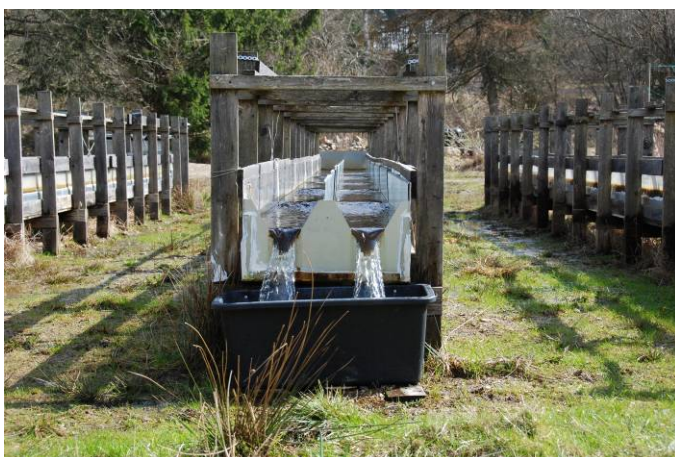
Figur 2. To af de i alt 12 forsøgsrender på Lemming feltstation. Renderne blev designet til at ligne rigtige vandløb med naturligt bundmateriale, vandhastighed og samfund af smådyr. Dyrene blev hentet fra den nærliggende Lemming Bæk, som også leverede det brugsvandet, som blev pumpet ind i hver rende.
