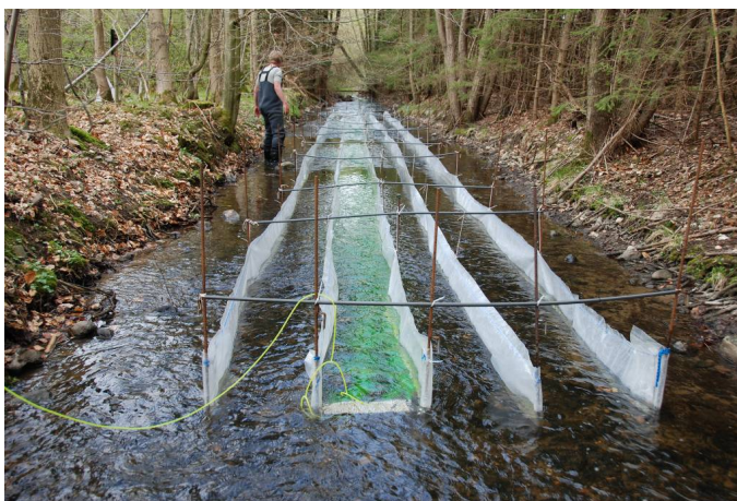
Figur 1. Forsøgsrenderne i Stavois Å blev afgrænset af søer plastikfolie, tynget ned mod den ujævne vandløbsbund med tunge jernkæder. Tilsætning af grønt farvestof viste, renderne sluttede ret tæt til bunden.
