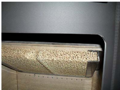
FIGUR 21: FOTO AF RAIS EPOCA MED KATALYSATOR UNDER RØGHYLDE.
