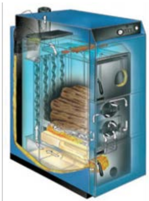
FIGUR 2: SNITTEGNING AF BAXI BONUS-KEDEL MED UNDERFORBRÆNDING
