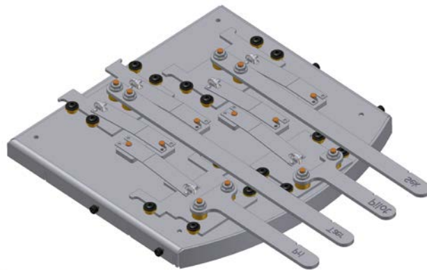
FIGUR 38: LUFTSYSTEM I BUNDEN AF TKK - SET NEDEFRA.
