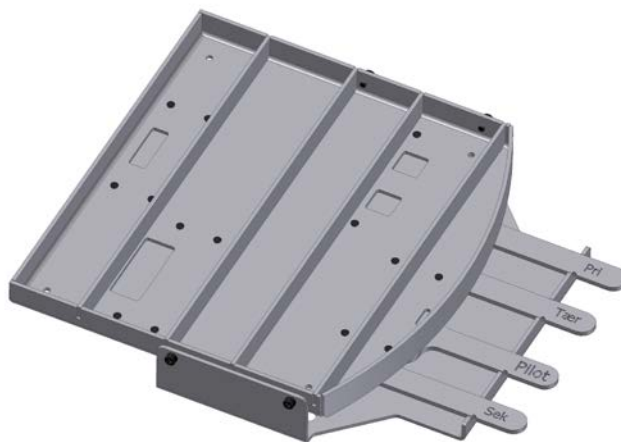
FIGUR 39: LUFTSYSTEM I BUNDEN AF TKK - SET OVENFRA.
