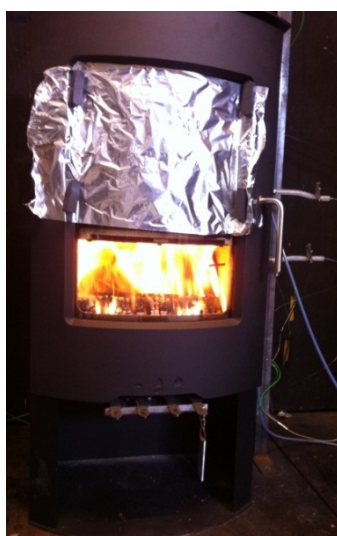
FIGUR 57: TKK VERSION 2, MED STRÅLINGSKÆRMNING.
