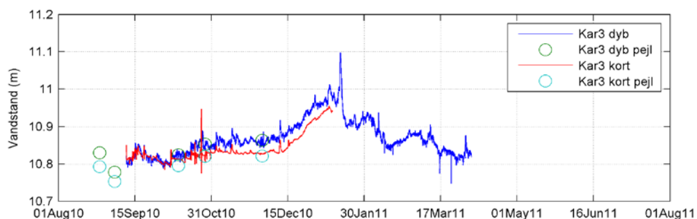
FIGUR 7. VANDSTAND KAR3. MÅLTE VANDSTANDSVARIATIONER I ET KORT PIEZOMETERRØR (H2-25) OG ET DYBT PIEZOMETERRØR (H2-176) PÅ LOKALITETEN KAR3 PÅ KARUP Å. TERRÆNKOTEN VED PIEZOMETERREDEN ER INDMÅLT TIL 10,76.
