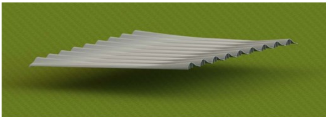
FIGUR 19 VINGER PARRET OP OG SAMLET SIDE OM SIDE TIL DANNELSE AF EN 310M 2 TAGFLADE
