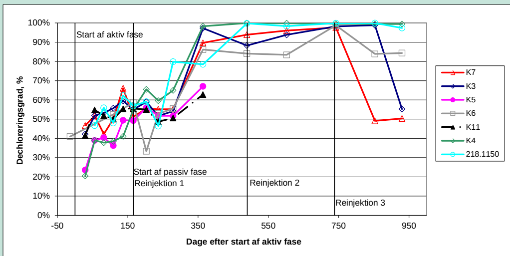
FIGUR 17 DECHLORERINGSGRAD I AKTIV OG PASSIV FASE. LÆS I TEKST OM USIKKERHED PÅ DECHLORERINGSGRAD VED SIDSTE VISTE MONITERINGSRUNDER.
