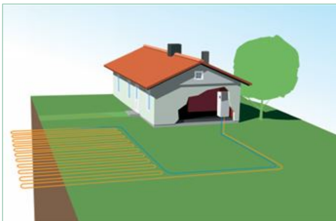
FIGUR 2.2 PRINCIPSKITSE FOR TERRÆNNÆRE, HORIZONTALT JORDVARMEANLÆG. FIGUREN ER UDLÅNT AF IVT NATURVARME.
