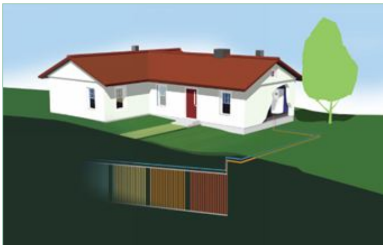
FIGUR 2.6 PRINCIPSKITSE FOR KOMPAKTANLÆG. FIGUREN ER UDLÅNT AF IVT NATURVARME.
