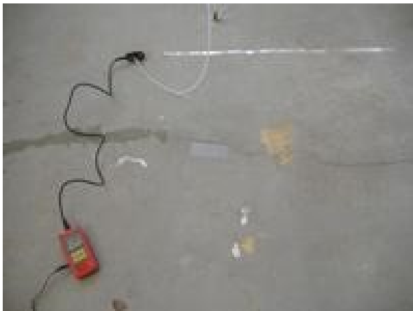
FIGUR 5 MÅLING AF TRYKFORSKELLE MELLEM UNDERSIDE AF GULV OG INDEKLIMA. TRYKDIFFERENSMÅLINGERNE AFSPEJLER RET PRÆCIST DE VARIERENDE TRYKFORHOLD, SOM ER I EN BYGNING OVER KORT OG LÆNGERE TID.
