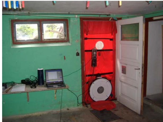
Eksempel på opsætning af BlowerDoor i en yderdør.
