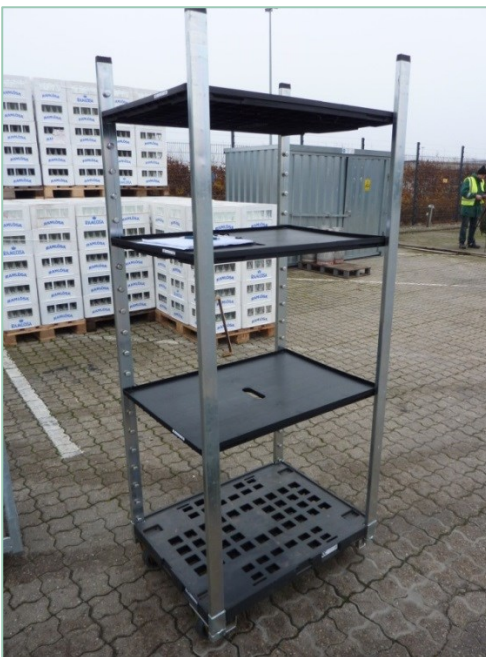
FIGUR 11. RULLECONTAINER (CC EURO TROLLEY). STØJSVAG, PIEK-CERTIFICERET
