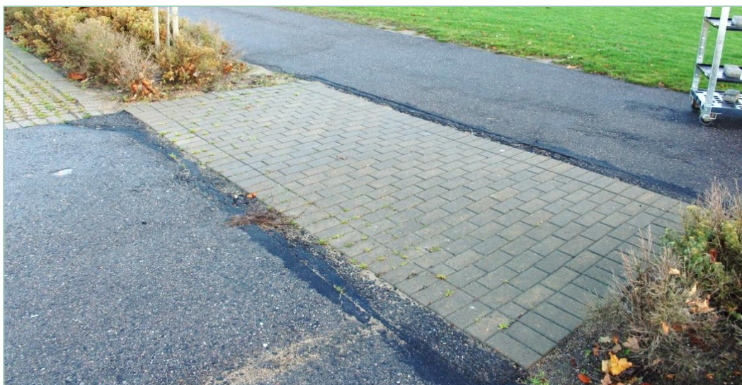
FIGUR 15. UNDERLAG ANVENDT VED MÅLING AF STØJ FRA PASSAGE AF OVERGANGE MELLEML FORSKELLIGE BELÆGNINGSTYPER. DER KAN VÆRE STOR FORSKEL PÅ STØJEN FRA FORSKELLIGE TYPER OVERGANGE MELLEML BELÆGNINGER.
