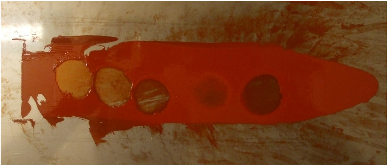
BILLEDE 12 AFRENSNING AF OFFSETFARVE. DE TO AFRENSEDE FELTER YDERST TIL VENSTRE ER DE TO MIKROEMULSIONER, I MIDTEN KONKURRENT- PRODUKTET, DERNÆST FEDTSYREESTERE TILSAT 3% EMULGATOR OG YDERST TIL HØJRE 3% A 5 I ORGANISK OPLØSNINGSMIDDEL
