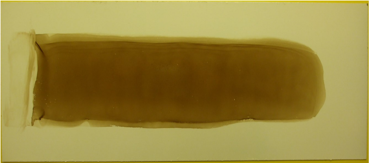
BILLEDE 4 ASFALT PÅ HVIDMALET STÅLPLADE
