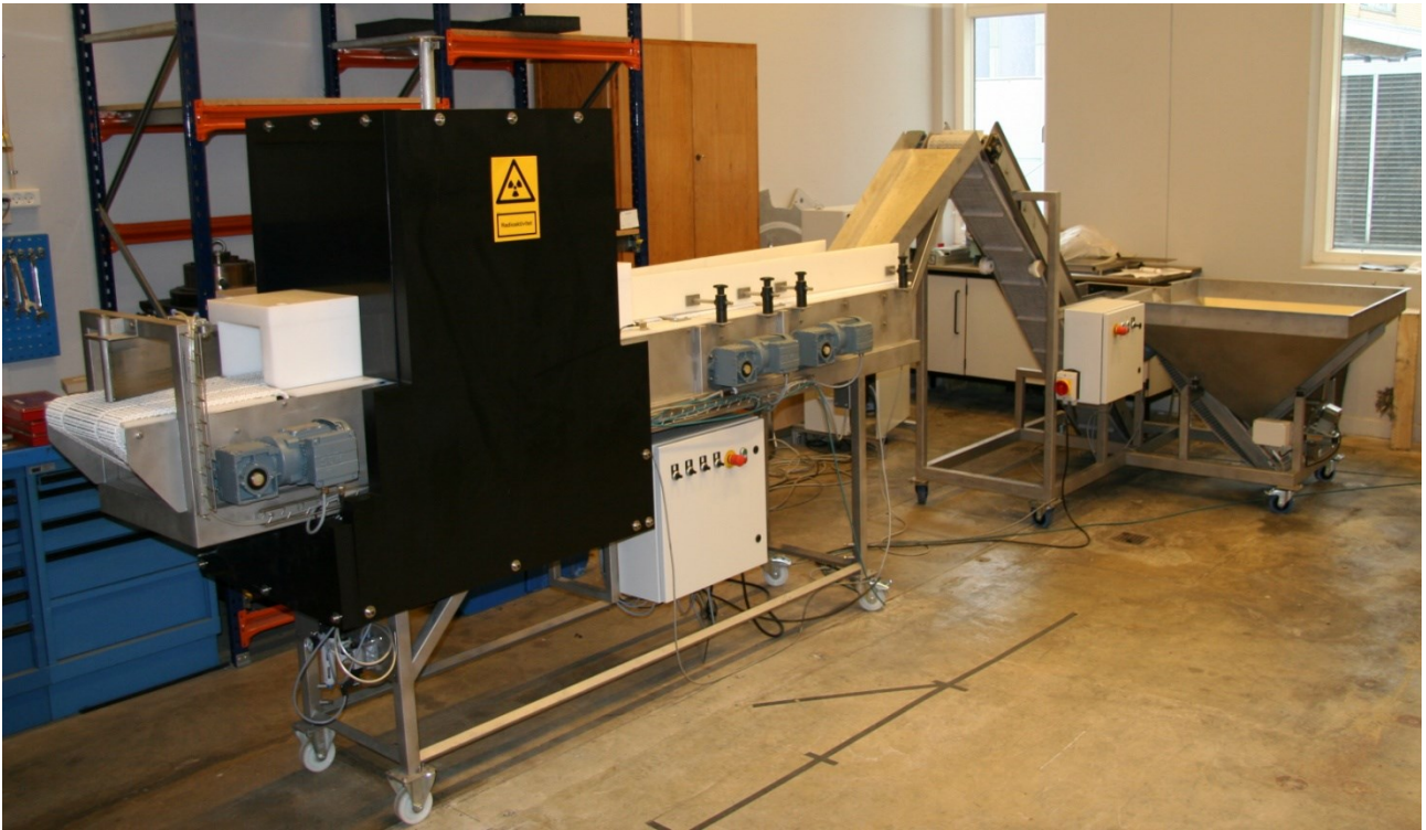
FIGUR 7: PGNAA-APPARATET BENYTTET TIL DETTE PROJEKT.
