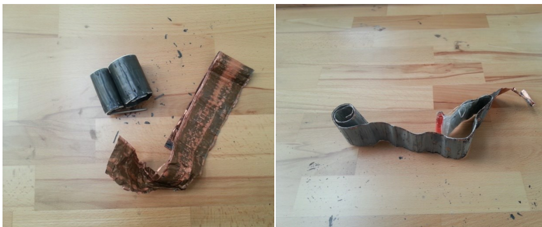
FIGUR 10: EKSEMPLER PÅ BATTERIELEKTRODER EFTER ADSKILLELSE
