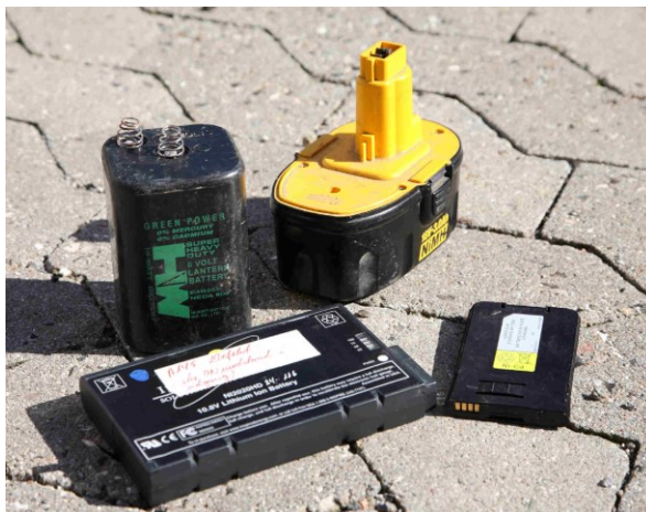
FIGUR 8: REPRÆSENTANTER FOR BATTERYPER: ZINK-CARBON, NIMH, LI-ION, NICD
