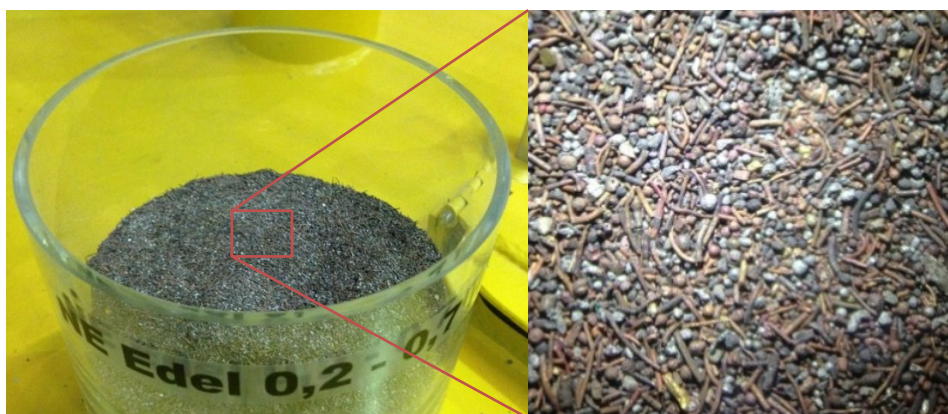
FIGUR 11 UDSORTERING AF IKKE-JERNHOLDIGE ÆDLE METALLER FRA TØR SLAGGE I STØRRELSEN 0,2-0,7MM. BILLEDET TH. VISER UDSORTERENGEN UNDER MIKROSKOP. DER SES INGEN TEGN PÅ VÆSENTLIG OXIDATION AF METALLERNES OVERFLADE.
