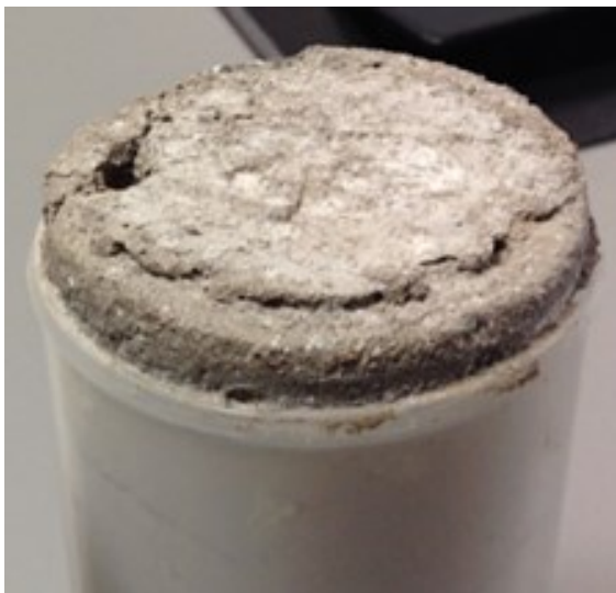
FIGUR 9 OPSVULMNING OG KRAKELERING AF STØRKNET SLAGGE SOM FØLGE AF OXIDERET ALUMINIUM. DEN VISTE SLAGGE ER FRA ET SCHWEIZISK ANLÆG INDEN METALUDSORTERING.
