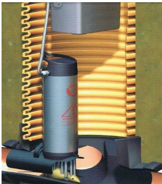
BILLEDE 48 ELEKTRONISKE ROTTESPÆRRE TIL BRUG FOR BEKÆMPELSE AF KLOAKROTTER HAR I MANGE KOMMUNER AFLØST BRUGEN AF GIFT.
