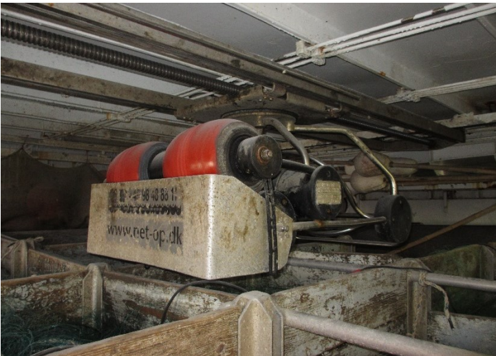
FIGUR 8. GARNOPREDER PÅ SKINNESYSTEM OPHÆNGT UNDER SHELTERDÆK OVER PAUNE 1-18. HØJDEN PÅ PAUNERNE ER 1,60 M. MED DEN LAVE FRIHØJDE OVER PAUNERNE ER DET IKKE MULIGT FOR BESÆTNING AT STAMPE GARNENE I PAUNERNE.
