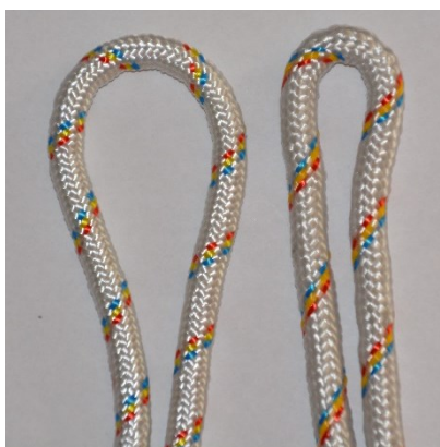
FIGUR 3. SYNKELINER MED ZINK INDFLETTET I 2 FORSKELLIGE MATERIALER: T.V. MED POLYESTER, T.H. MED POLYPROPYLEN
