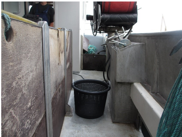
FOTO 5. AFSTANDEN MELLEM PAUNER OG LØNNING ER REDUCERET TIL EN BREDDE, DER LIGE AKKURAT TILLADER PASSAGE OG PLACERING AF KURVE TIL FANGSTEN. PÅ FOTOET SES OGSÅ STYREPULT, HVORFRA FARTØJET MANØVRES UNDER ARBEJDE MED GARN.
