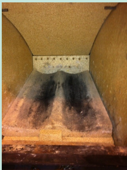
FIGUR 20 BRÆNDKAMMER I LOLE-2 MED 9 HÆVEDE TERTIÆRHULLER I BAGSIDEN
