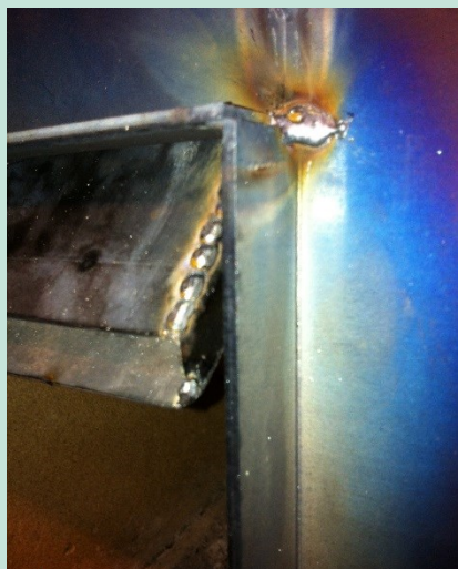
FIGUR 19 LUFTLÆBE MED PÅSVEJSNING AF ENDESTYKKER.
