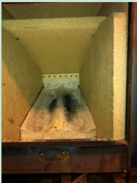
FIGUR 21 LOLE-3 MED 2X25MM SKAMOL EKSTRA I SIDERNE OG KUN 7 TERTLÆRHULLER I BAGPLADEN.
