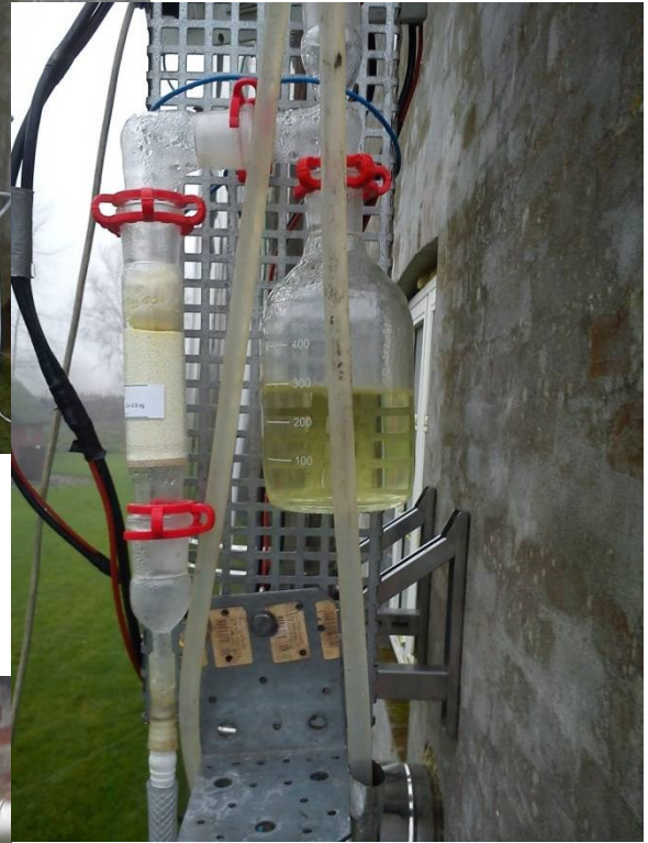
Billede 5: Opsamling af kondensat til dioxinanalyse
