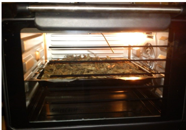
Billede 2: Tørring af flisprøve
