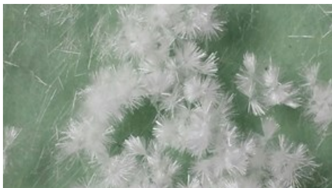
FIGUR 26: FOSFORKRISTALLER INDDAMPET EFTER FOSFORUDVINDING MED EDS
