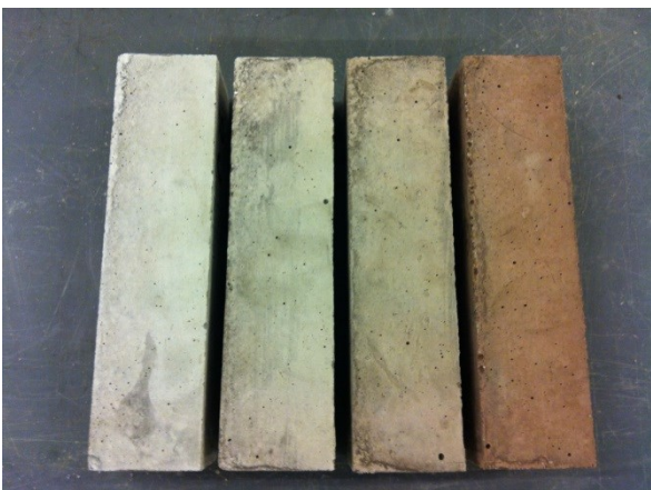
FIGUR 32: MØRTELPRØVER. FRA VENSTRE EN REFERENCEPRØVE OG HEREFTER MØRTELPRØVER MED 2,5%; 5% OG 10% CEMENT ERSTATTET MED MINERALSK REST FRA AVEDØREASKE
