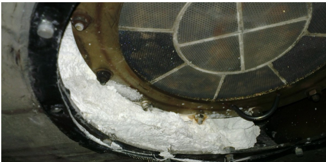
FIGUR 14 UDKRSTALLISERING AF UREA (HVIDE AFLEJRINGER) MELLEM FILTER OF KATALYSATOR (BUS7-EEV-EGR). KRYSTALLISERINGEN ER BEGYNDT 10-20 CM EFTER INJEKTIONSPUNKTET FOR ADBLUE® OG HAR DEREFTER ARBEJDET SIG MOD FLOWRETNINGEN HEN MOD PARTIKELFILTERET.
