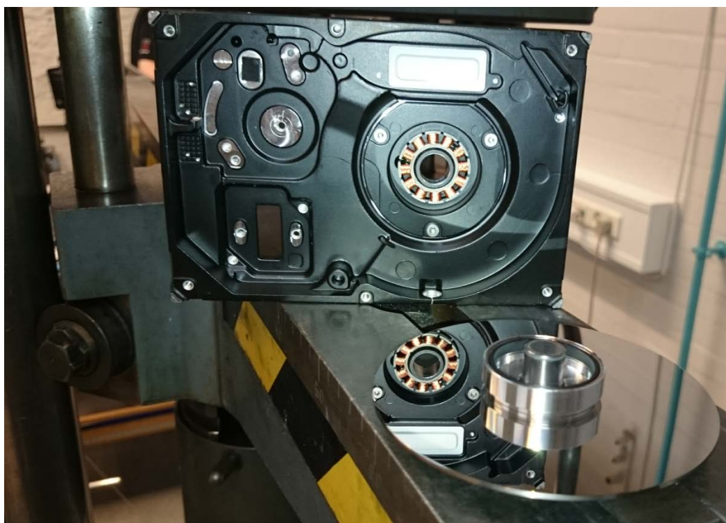
FIGUR 29 PLADELAGER AFMONTERET MED PRESSECYLINDER. DER PRESSES MED EN KRAFT PÅ MELLEM 3,5 OG 6 KN.
