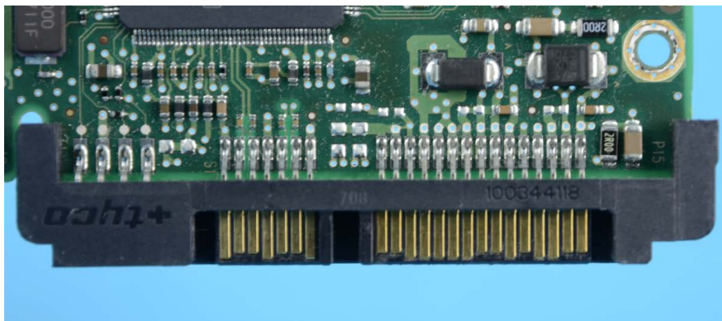
FIGUR 10 NÆRBILLEDE AF DET STIK DER BRUGES TIL AT FORBINDE HARDDISKEN TIL STRØM (VENSTRE DEL) OG DATAKOMMUNIKATION (HØJRE DEL). DE GULE OMRÅDER PÅ STIKKET ER BELAGT MED NIKKEL OG GULD. DENNE VERSION AF STIKKET ER DEN NYERE SERIELLE TYPE DER KALDES SATA.
