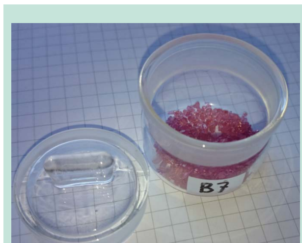
FIGUR 1 KRYSTALLER AF NEODYMSULFAT DANNET FRA EN OPLØSNING AF HARDDISK MAGNETER.
