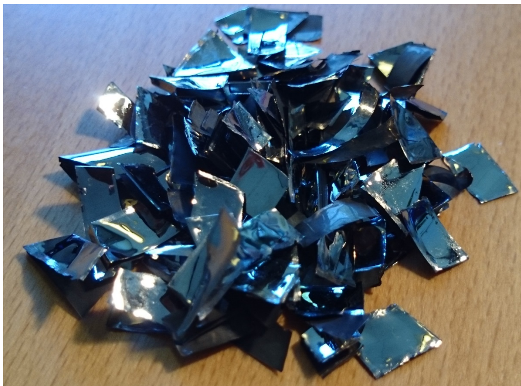
FIGUR 15 FOLIEFLAGER AF KEMISK NIKKEL MED DE TYNDE MAGNETISKE LAG ØVERST (LYSESTE SIDE). FOLIEFLAGERNE ER FREMSTILLET VED AT KLIPPE PLADELAGERET I STRIMLER OG OPLØSE ALUMINIUMSUBSTRATET I NATRIUMHYDROXID. DEREFTER KAN FLAGERNE, DER BESTÅR AF NIKKEL, KOBOLT OG PLATIN, FILTRERES FRA.
