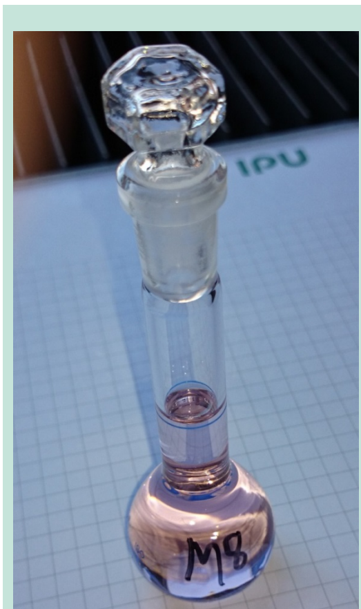
FIGUR 19 FOTO AF EN MÅLEKOLBE MED OPLØSTE MAGNETER EFTER BORTFILTRERING AF NIKKELBELÆGNING OG BOR.
