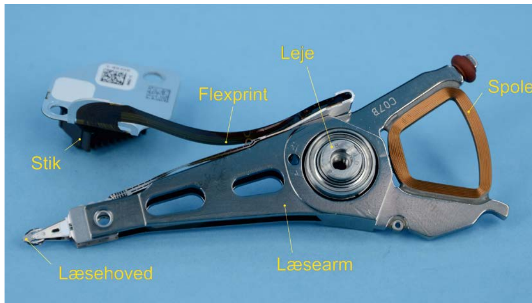
FIGUR 13 NÆRBILLEDE AF EN LÆSEARM MED SPOLEN DER POSITIONERER LÆSEHOVED ET STED PÅ PLADELAGERET, VED AT DREJE ARMEN OMKRING LEJET. FLEXPRINTET LEDER INFORMATIONERNE DER LÆSES AF LÆSEHOVEDET, VIA ET STIK OG ET HUL I RAMMEN, OM TIL PRINTPLADEN PÅ BAGSIDEN.
