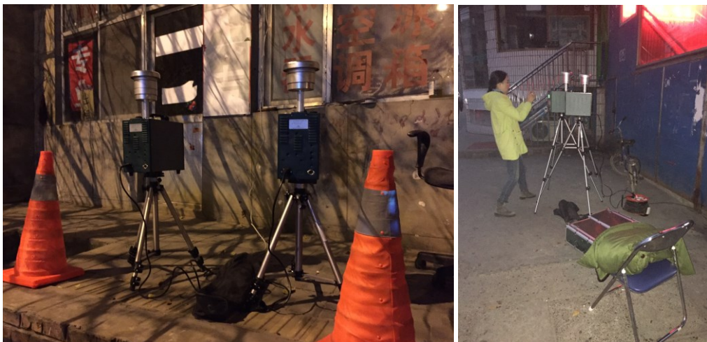
Målestation: opsamling af partikler på filtre til bestemmelse af PM 10 og PM 2,5.
