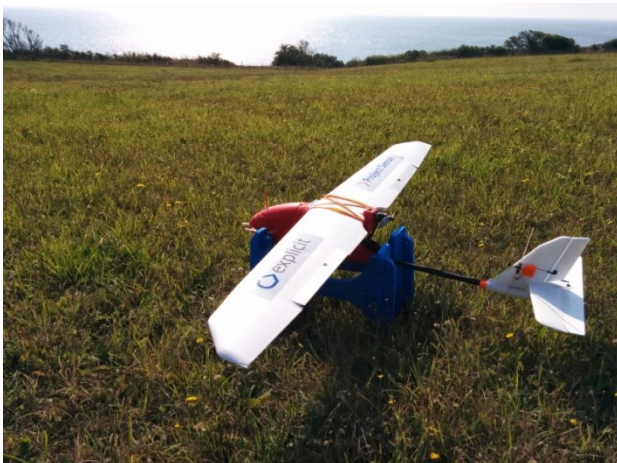
BILLEDE 9 DRONE MODEL 3DROBOTICS AERO, MONTERET MED NOX-SENSORBOKS.
