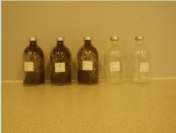
Figur. Batchforsøg med kompost til test af metanoxidations- og respirationsrate (kontroltest til højre)
