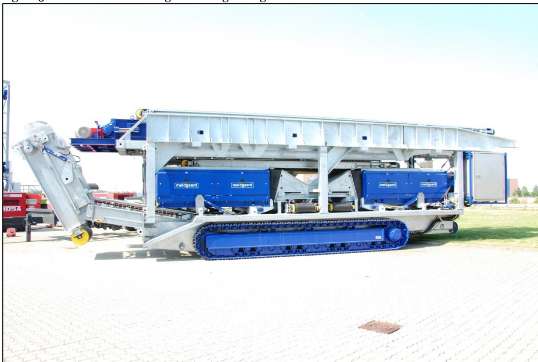
Figur 15: Foto af det helt færdige sorteringsanlæg:
