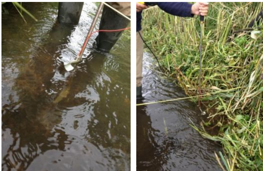
FIGUR 3.2 VANDFØRINGSMÅLINGER MED VINGE PÅ TVÆRS AF ET VANDLØB
