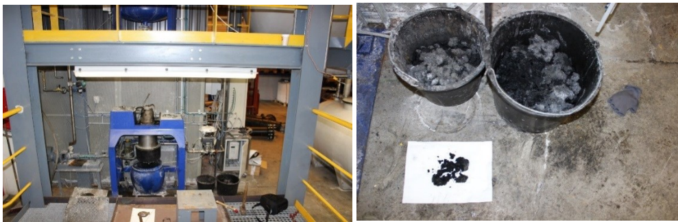
Figur 27: Dekanter (PureDry) for opkoncentrering af slammet fra separatoren til fast sod der blev opsamlet i spande og vejlet løbende under 150 timers testene.
