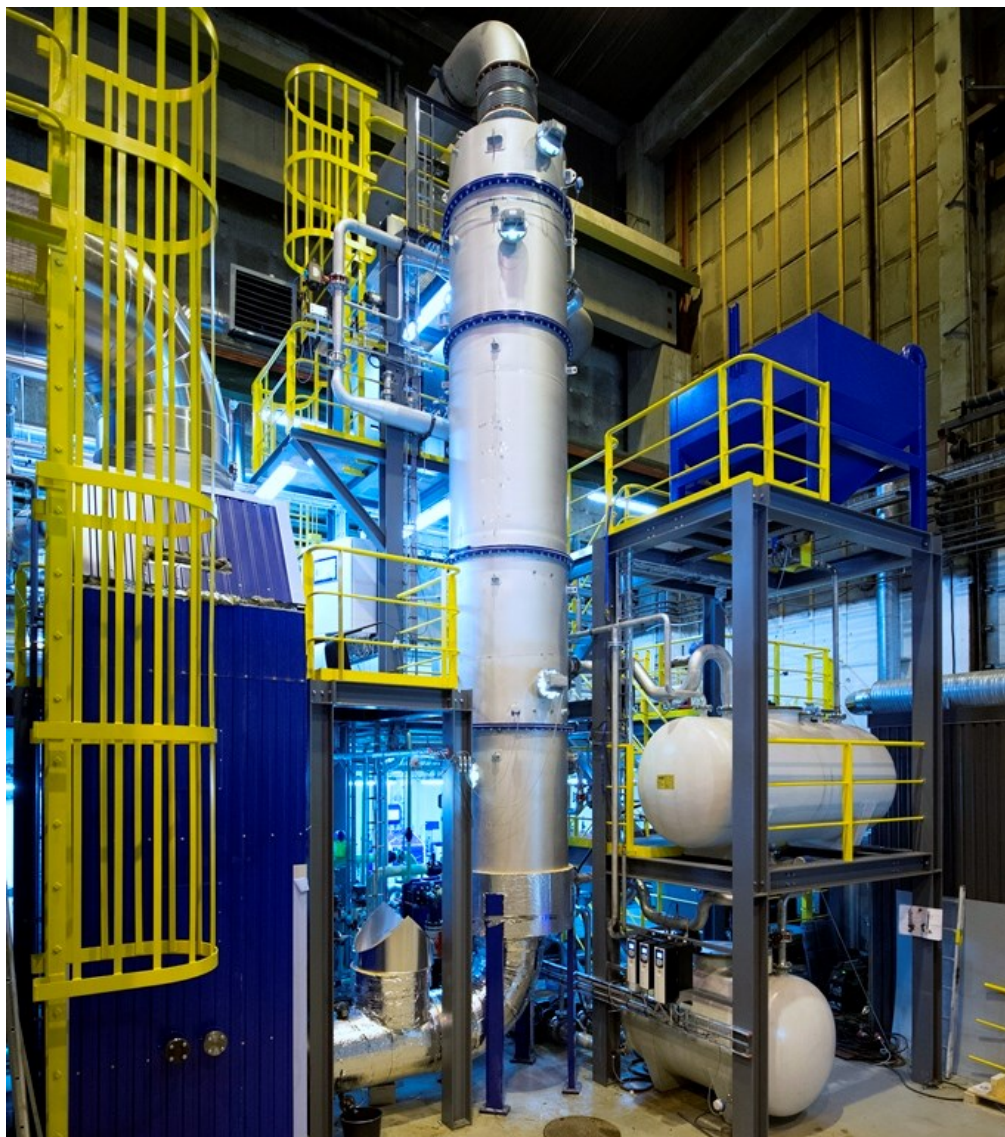
Figur 19: In-line scrubber med REFLEX princip designet og testet som en del af dette projekt.
