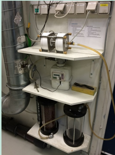
FIGUR 19 NS 3058 PLANFILTERHOLDER BENYTTET TIL OPSAMLING AF STØV
