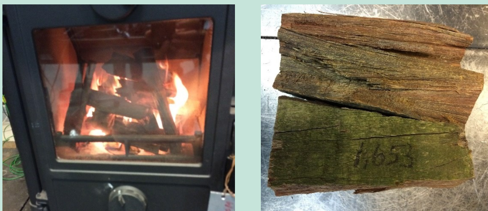
FIGUR 23 OPTÆNDING MED MINDRE STAVE AF KREOSOTTRÆ (VENSTRE) OG KREOSOTTRÆ TIL EN PÅFYRING (HØJRE)
