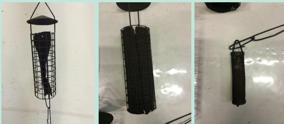
FIGUR 24 FOTOGRAFIER AF TRE ORM EFTER AFBRÆNDING AF MALET TRÆ. ADSORPTIONSMATERIALERNE ER (FRA VENSTRE MOD HØJRE): SILIKONEFILM, PURSKUM OG XAD 2 . HOLDERNE OG ADSORPTIONSMATERIALERNE ER HOVEDSAGELIGT SORTE PÅ GRUND AF OPSAMLING AF SODPARTIKLER.
