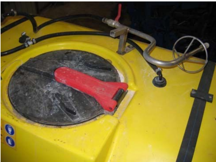
TÅGESPRØJTE MED MONTERING AF DUNK TIL SKYLNING AF TOM EMBALLAGE. FOTO: NIELS ENNGAARD KLAUSEN
