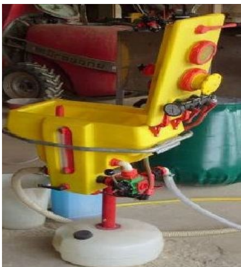
PRÆPARATFYLDEUDSTYR, HVORFRA SPRØJTEMIDLERNE SUGES OP I SPRØJTEN
