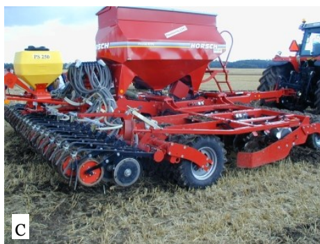
FIGUR 4-2. MASKINTYPER ANVENDT I DYRKNINGSSCENARIE 2 OG 3. A: TALLERKENHARVE AF FABRIKATET "AMAZONE CATROS" TIL AT LAVE FALSK SÅBED (I VINTERSÆD). B: TANDHARVE ELLER KULTIVATOR AF FABRIKATET "VÅDERSTAD CULTUS" TIL DEN PRIMÆRE JORDBEARBEJDNING (OPHARVNINGEN I BEGGE DYBDER). BEMÆRK DEN PÅMONTEREDE SÅMASKINE "BIODRILL", SOM BLIVER BRUGT TIL AT SÅ VINTERRAPSEN MED SAMTIDIG MED HARVNINGEN. C: SKIVESKÆRSÅMASKINE AF FABRIKATET "HORSCH PRONTO".
