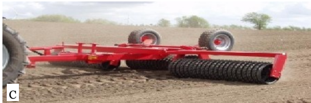
FIGUR 4-1. MASKINTYPER ANVENDT I DYRKNINGSSCENARIE 1. A: 6-FURET VENDEPLOV (KVERNELAND EG) MED JORDPAKKER, B: ROTORHARVE-SÅSÆT (AMAZONE), C: TROMLE (HE-VA)
