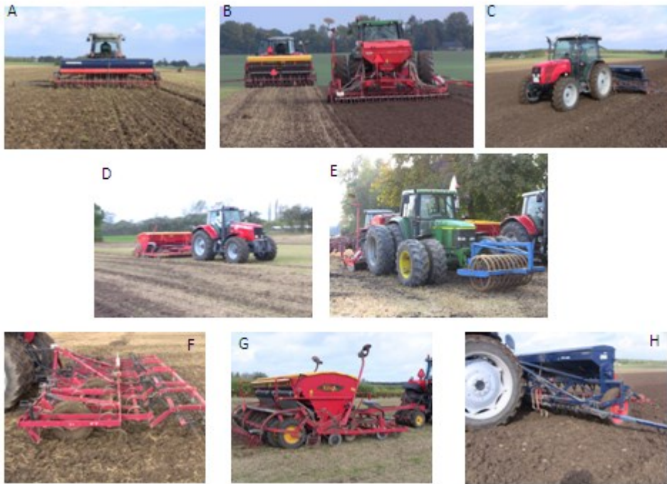
FIGUR 2-1. BILLEDER AF MASKINSÆT TAGET I FORBINDELSE MED JORDBEARBEJDNINGEN DEN 2. OKTOBER 2012. A-C: SÅMASKINER OG TRAKTORER ANVENDT VED ETABLERING AF BEHANDLINGERNE F1-F4 (I RÆKKEFØLGE; SAMME MASKINSÆT I F1 OG F4). D OG E: TRAKTOR OG SÅMASKINER ANVENDT HHV. I F2 OG F3 (SET FORFRA; I F2 ER DER CA. 60 CM BREDE ENKELTMONTEREDE DÆK PÅ TRAKTOREN, I F3 ER TRAKTOREN UDSYSTRET MED CA. 60 CM BREDE TVILLINGMONTEREDE DÆK). F: SÅBEDSHARVE ANVENDT I F1 (BILLETET) OG I F4 (IKKE VIST). G: SKIVESKÆRMASKINEN ANVENDT I F2 (HARVEN MONTERET FORAN SÅMASKINEN HÆVES OP OVER JORDEN I FORBINDELSE MED FORSØGSBEHANDLINGEN). H: JORDEN I F1 OG F4 PAKKES AF RELATIVT SMALLE HJUL PÅ TRAKTOR (CA. 50 CM BREDE BAGDÆK) OG SÅMASKINE, MEN SPORENE BLIVER KUN SYNLIGE I F4. DE SAMME MASKINER BLEV ANVENDT I 2013.
