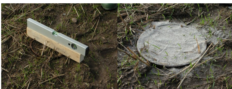
FIGUR 2-4. FORBEREDELSE AF MÅLEFELT TIL INFILTRATIONSMÅLING (FORSØGSOPSTILLING). VENSTRE SIDE: FELTET AFGRÆNSES MED EN SKARPTSLEBET STÅLRING. RINGEN BANKES FORSIGTIGT CA. 2 CM NED I JORDEN SÅLEDES AT HULRUMMET MELLEM DEN UFORSTYRREDE JORDOVERFLADE OG RINGENS OVERKANT BLIVER MINDST MULIG. DET SIKRES AT RINGENS OVERKANT LIGGER VANDRET. HØJRE SIDE: HULRUMMET MELLEM JORDOVERFLADEN OG RINGENS OVERKANT FYLDES MED SAND, SOM SIKRER GOD HYDRAULISK KONTAKT MELLEM TENSİOMETER OG JORDOVERFLADE.
