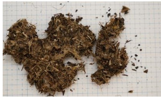
BILLEDE 12 FOTO, FRA BATCH 6 MED 75% HPA SPAND VISER TØRRET BIOPULP OVER 1,3 MM
