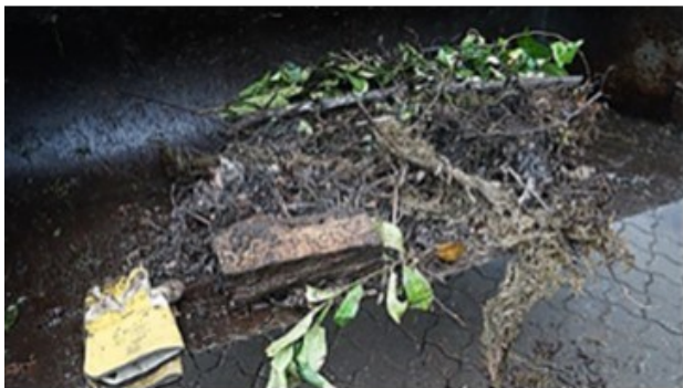
BILLEDE 21 FOTOS FRA TESTSERIE 3; EFTER BESTEMMELSEN AF RUMVÆGT UDTAGES EN RÆKKER MINDRE PRØVER FOR BESTEMMELSE AF VANDINDHOLD OG ASKEINDHOLD
