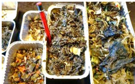
BILLEDE 4 FOTO AF DE FINE DEL FRAKTIONER. BEMÆRK HVORLEDES DET ER MULIGT AT FASTLÆGGE HVAD DEN ORGANISKE FRAKTION BESTÅR AF.
