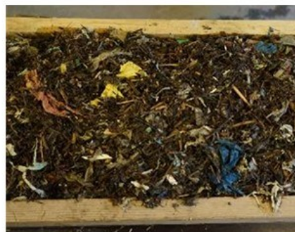
BILLEDE 31 FOTO VISER VASKET OG FORBEHANDLET REJEKT FRA BATCH 4, 50% HPA SPAND
