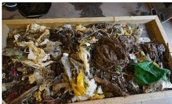
BILLEDE 31 FOTO VISER VASKET OG FORBEHANDLET REJEKT FRA BATCH 4, 50% HPA SPAND
