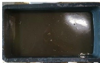
BILLEDE 5 ØVERST, REJEKT TØMMES EFTER VASKE I BLANDEMASKINE MIDT OG NEDERST, VASKEVAND FILTERES FOR AT MÅLE ANDLEN AF FINE PARTIKLER
