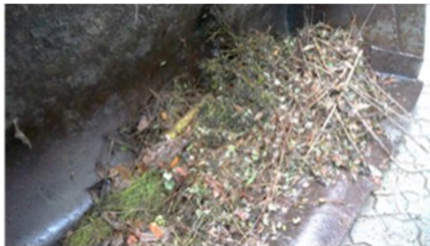
BILLEDE 21 FOTOS FRA TESTSERIE 3; EFTER BESTEMMELSEN AF RUMVÆGT UDTAGES EN RÆKKER MINDRE PRØVER FOR BESTEMMELSE AF VANDINDHOLD OG ASKEINDHOLD
