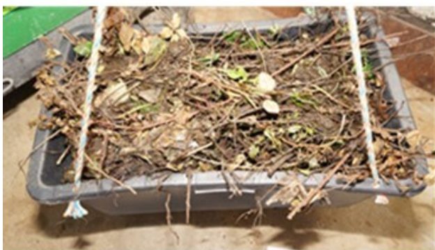
BILLEDE 20 FOTOS FRA TESTSERIE 2 AF BESTEMMELSEN AF RUMVÆGT VED VEJNING I 60 LITER KAR
