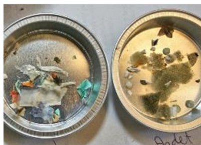
BILLEDE 3 ØVERST, DE TØRREDE PARTIKLER INDEN DE HÅNDSÅRTERES NEDERST, ANDEL AF PLASTIK OG ANDET I DEN SORTEREDE PRØVE
