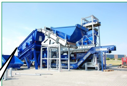
Figur 16: Testkørsel af forsigte og Triple Eddy Current, uden slagge. Kilde: Meldgaard Recycling A/S
