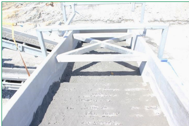
Figur 8: Tilstoppet sigte i vibrationssigte (med nærbillede af tilstopning). Kilde: Meldgaard Recycling A/S.
