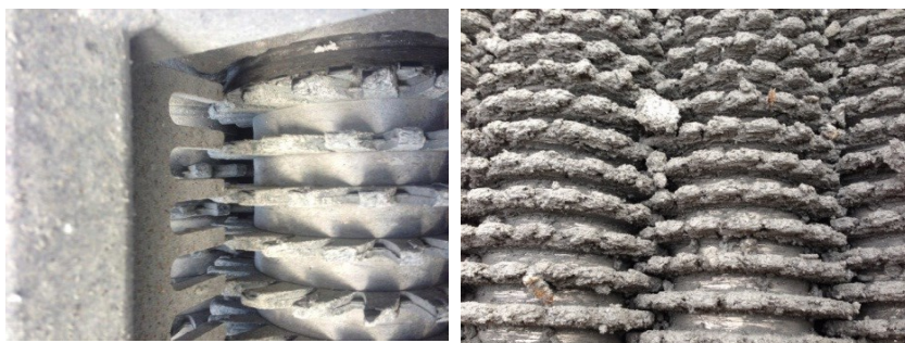
Figur 11a & b: Tilstoppede/nedslidte stjernesigter med tydelige plamager af vådt og klistret slagge. Kilde: Meldgaard Recycling A/S
