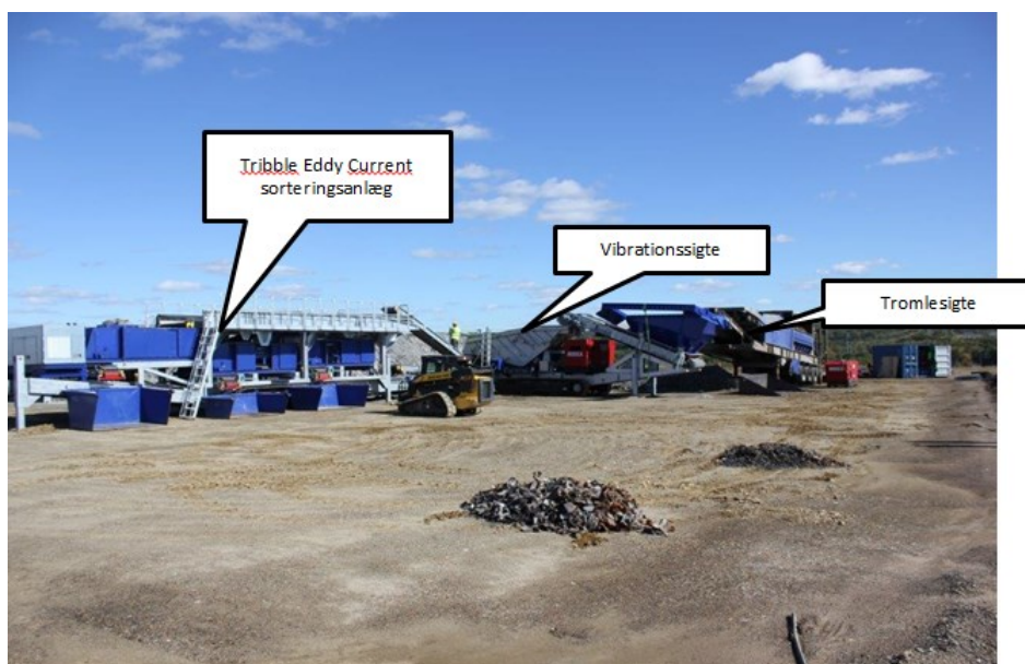
Figur 5: Første opstilling på Wheelabrator Putnam Inc.'s slaggedeponeringsanlæg, Putnam, Connecticut. Kilde: Meldgaard US Inc.
